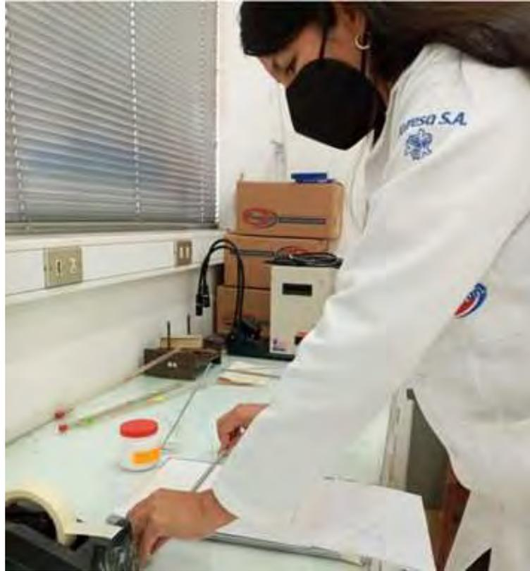
**Figura 38.** Técnica de recubrimiento sobre el soporte de celulosa, empleando la barra Mayer 10.
