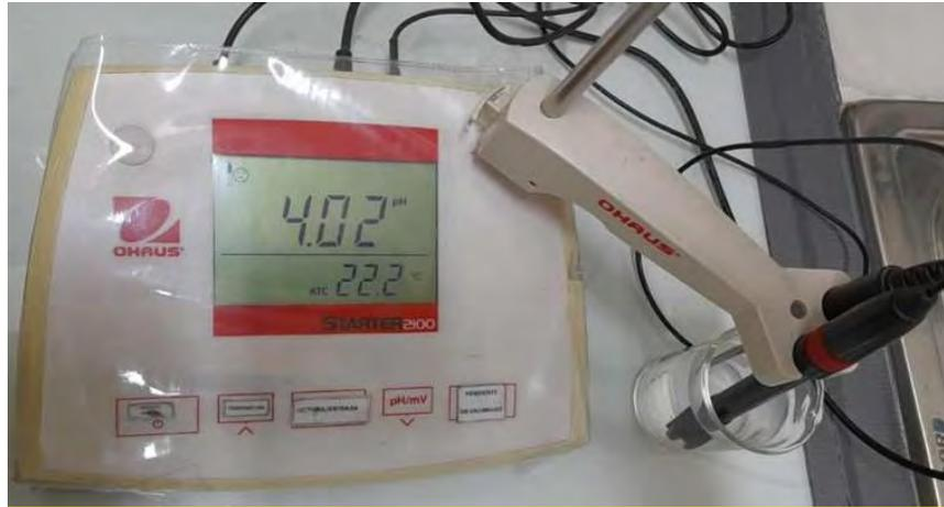
**Figura 34.** Determinación del valor de pH de las soluciones preparadas.
