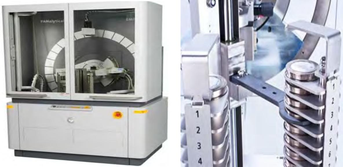
**Figura 45.** Difractómetro de rayos X Malvern Panalytical con fuente de cobre. a) Imagen del equipo DRX, b) detalle del portamuestras
