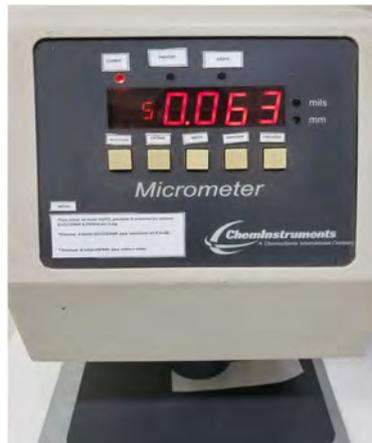
**Figura 40.** Micrómetro electrónico empleado en la determinación del espesor total del cuerpo de prueba tipo sándwich.
