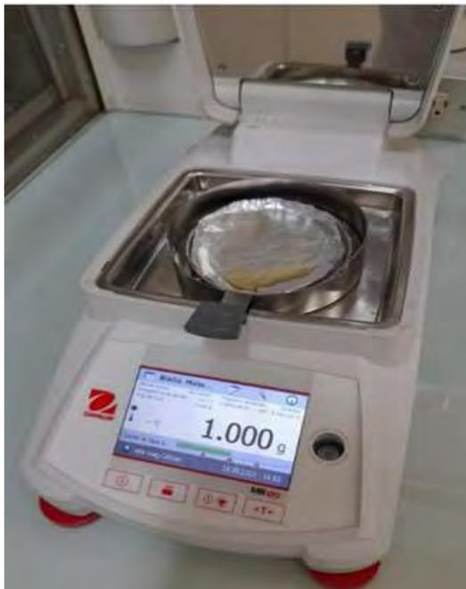
**Figura 33.** Fotografía referencial del analizador termogravimétrico.
