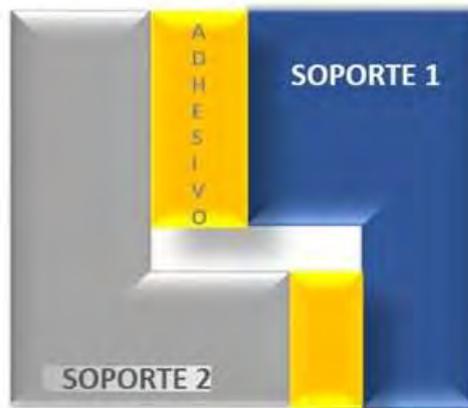
**Figura 22.** Unión de soportes por un adhesivo.
