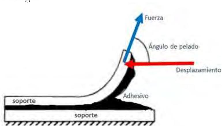
**Figura 26.** Descripción del sentido de la fuerza y desplazamiento en un ensayo de tracción<sup>79</sup>.
