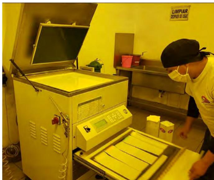
**Figura 66.** Muestras tipo sándwich dentro de la cámara de irradiación UVC.
