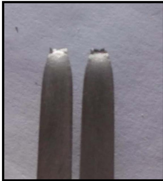
**Figura N° 4.79:** Probeta de acero inoxidable dúplex SAF 2205, expuesta a la condición de 30% de  $H_2SO_4$  a  $40^\circ C$ , ya traccionada. (Fuente: el Autor).
