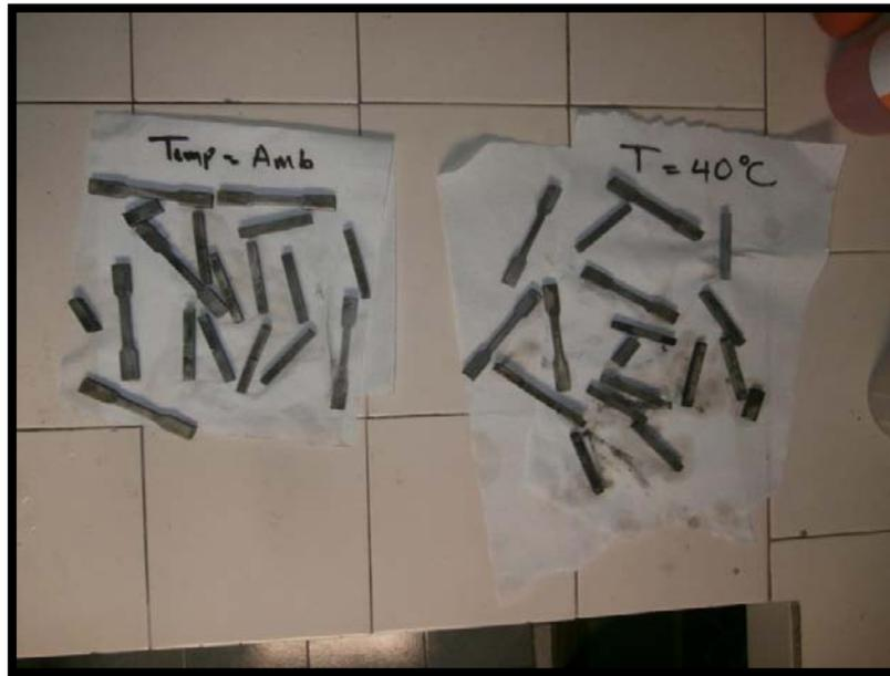
**Figura 4.22:** Lavado y secado de muestras a 30% de  $H_2SO_4$  luego de permanecer por 12 horas, a la izquierda temperatura ambiente y a la derecha temperatura de  $40^{\circ}C$ . (Fuente: el Autor).
