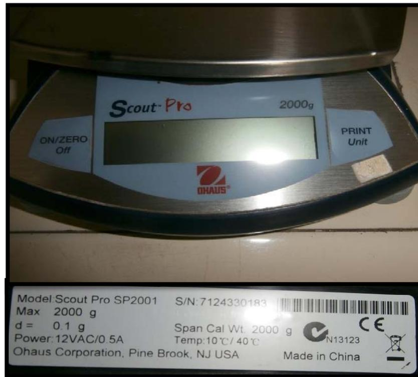
**Figura 3.7:** Balanza electrónica usada en el Laboratorio para la toma del peso.
