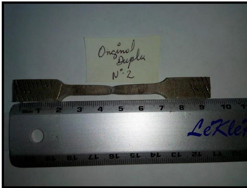
**Figura 4.29:** Toma de valores de elongación en probetas ya traccionadas.
