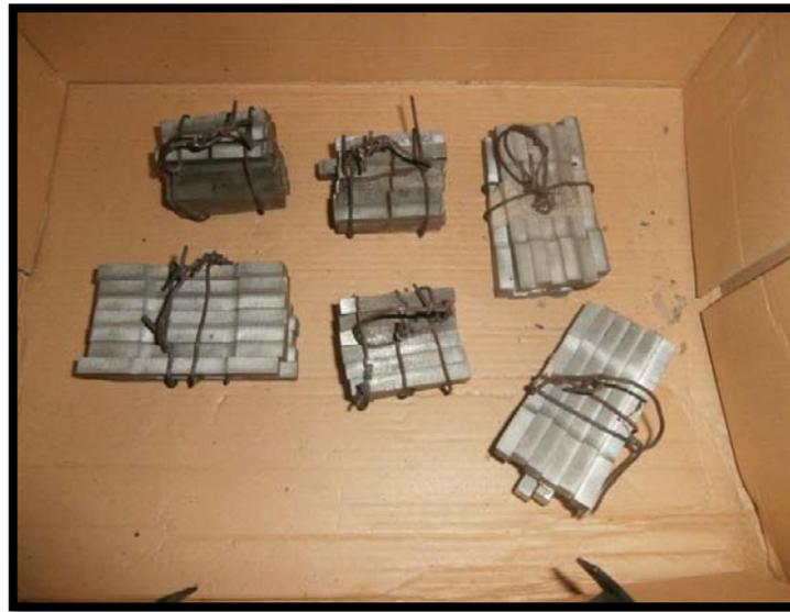
**Figura 4.12:** Agrupación de muestras de acero dúplex SAF 2205 y acero inoxidable 316L para someterlas al proceso de sensibilización. (Fuente: el Autor).
