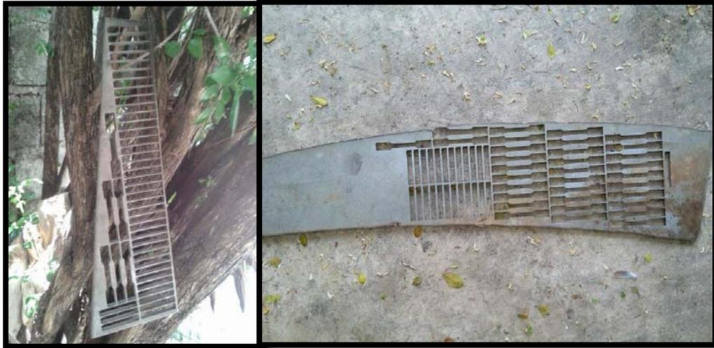
**Figura 4.11:** Sección de acero dúplex SAF 2205 en la cual ya se extrajeron las probetas. (Fuente: el Autor).
