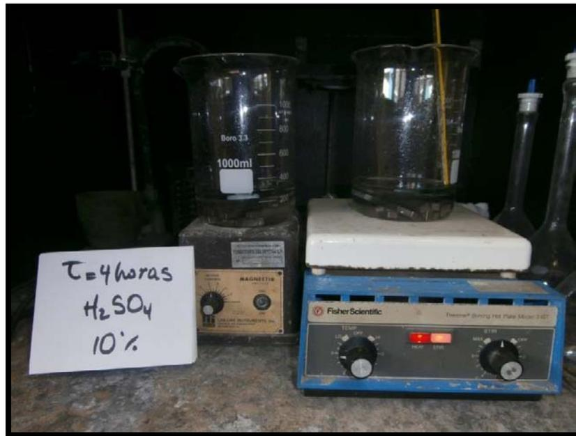
**Figura 4.24:** Montaje de muestras a 10% de  $H_2SO_4$  al momento de llevar 4 horas el ensayo, a la izquierda temperatura ambiente y a la derecha temperatura de  $40^{\circ}C$ . (Fuente: el Autor).
