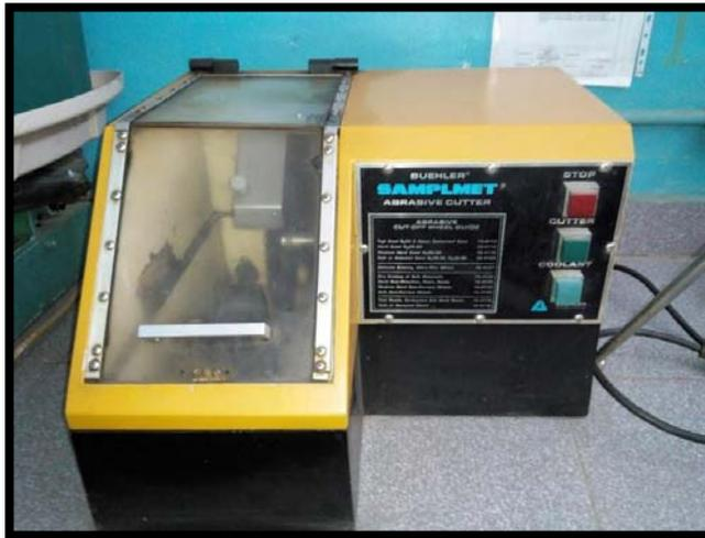
**Figura N° 3.11:** Cortadora Metalográfica. (Fuente: el Autor).
