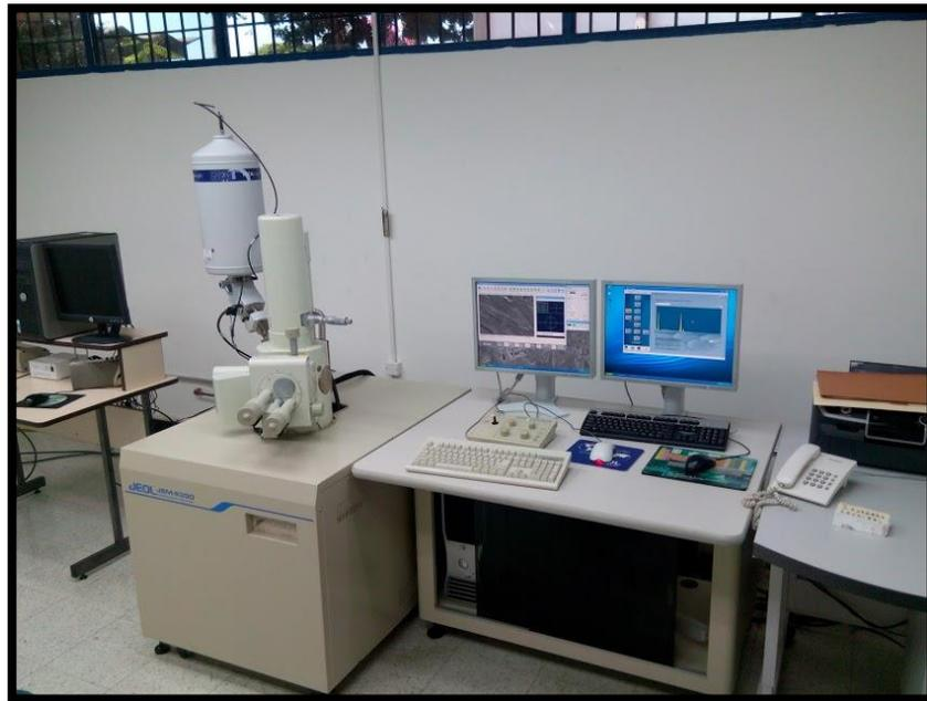
**Figura N° 3.16:** Microscopio Electrónico de Barrido marca JEOL modelo JSM-6390. (Fuente: el Autor).
