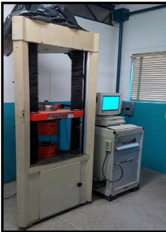
**Figura: 3.10:** Equipó de Ensayos Universales del Departamento de Materiales de la UC. GALDABINI. (Fuente: el Autor).
