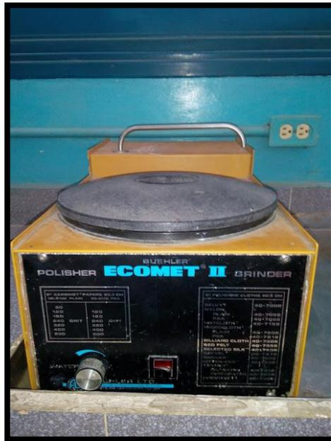
Figura N° 3.13: Mesa de desbaste marca BUEHLER. (Fuente: el Autor).
