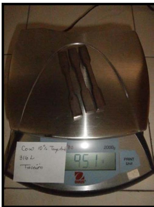
**Figura 4.16:** Registro de peso inicial de probetas de tracción para la condición de 10% de H<sub>2</sub>SO<sub>4</sub> a temperatura ambiente. (Fuente: el Autor).
