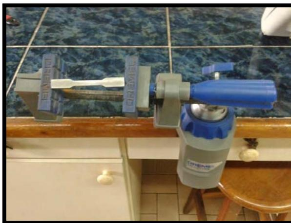
**Figura N° 3.3:** Montaje de muestras para ensayo de PMI con el Equipo de PMI X-Met3000TX a muestras acero 316L. (Fuente el Autor).
