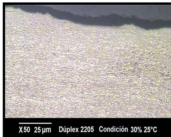
**Figura N° 4.61:** Microestructura del acero dúplex SAF 2205 a 50x, por microscopía óptica, condición de 30% de  $H_2SO_4$  a 25°C. (Fuente: el Autor).
