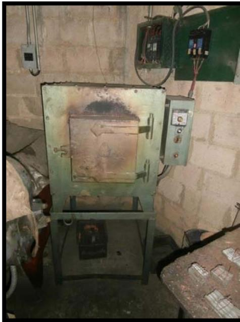
**Figura 3.6:** Mufla eléctrica del taller Fretorma usada para el proceso de Sencibilizacion. (Fuente: el Autor).
