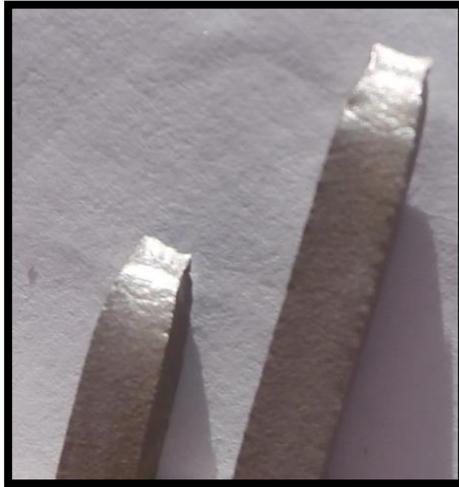
**Figura N° 4.69:** Probeta de acero inoxidable 316L expuesta a la condición de 30% de  $H_2SO_4$  a  $40^\circ C$ , ya traccionada. (Fuente: el Autor).
