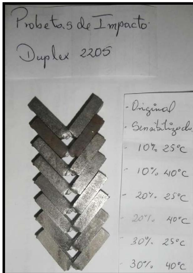
**Figura N° 4.68:** Probetas del ensayo de impacto Charpy en V de acero inoxidable dúplex SAF 2205. (Fuente: el Autor).
