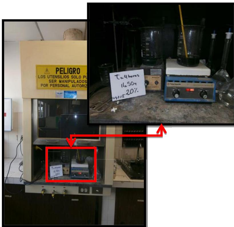
**Figura 4.23:** Montaje de muestras a 20% de  $H_2SO_4$  al momento de llevar 4 horas el ensayo, a la izquierda temperatura ambiente y a la derecha temperatura de  $40^{\circ}C$ . (Fuente: el Autor).
