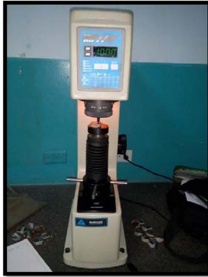
**Figura N° 3.17:** Equipo de dureza ROCKWELL B marca BUEHLER del laboratorio de materiales de la Escuela de Ingeniería Mecánica de la UC.
