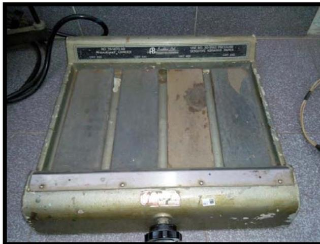
**Figura N° 3.12:** Mesa de desbaste marca BUEHLER. (Fuente: el Autor).
