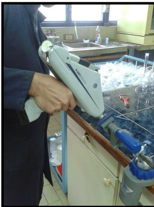
**Figura N° 3.2:** Análisis por PMI con el Equipo de PMI X-Met3000TX a muestras acero 316L. (Fuente el Autor).
