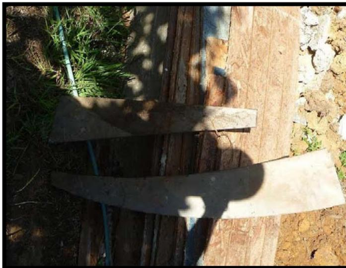
**Figura N° 4.3:** Secciones de lámina de acero inoxidable dúplex SAF 2205 suministrada por la empresa TRIMECA. (Fuente el Autor).
