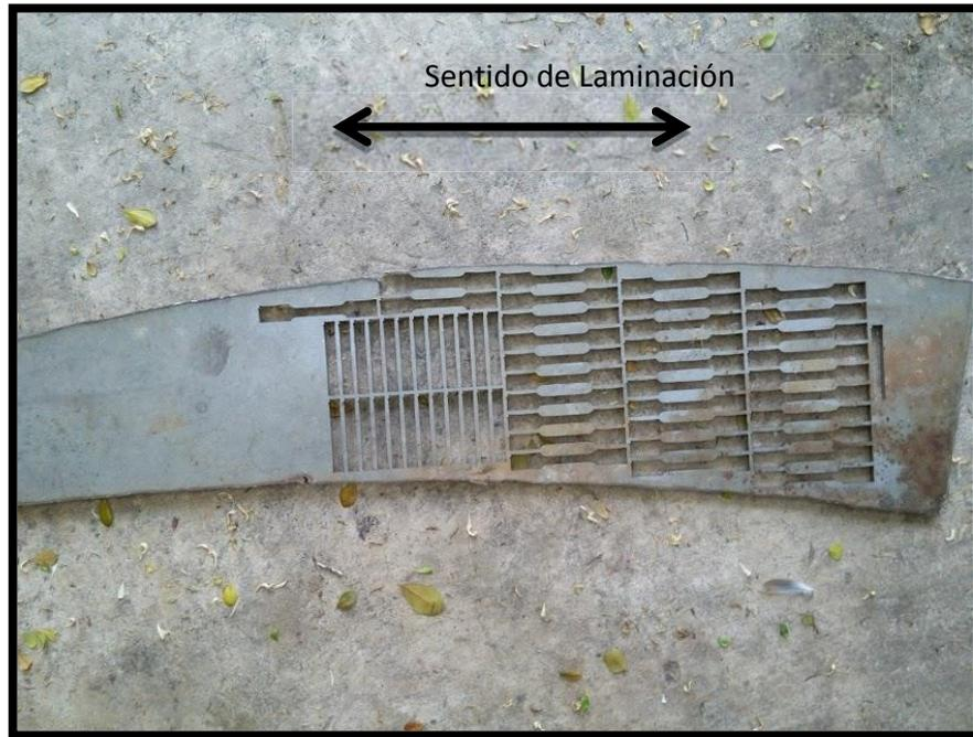
**Figura 4.9:** Sección de acero dúplex SAF 2205 en la cual se indica sentido de laminación. (Fuente: el Autor).
