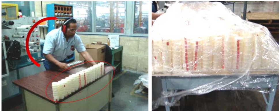
Figura 26. Inclinación del operario durante la ubicación y almacenamiento de cintas.
