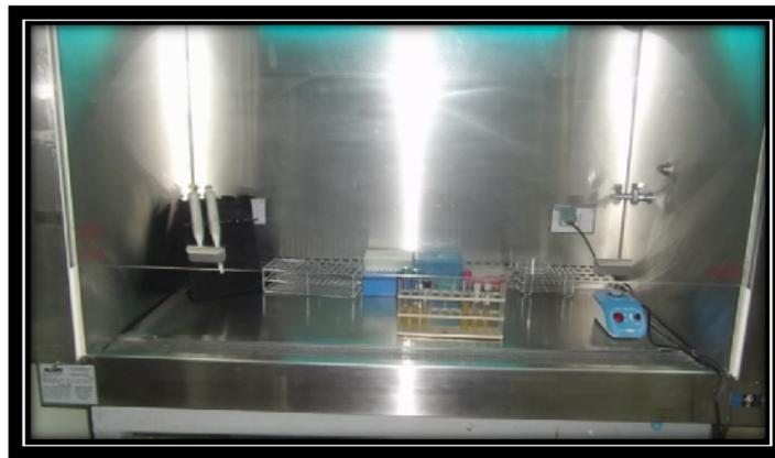
*Figura N° 6: Cámara de anaerobiosis donde se realizó la contaminación de los 60 tubos de ensayos que contenían caldo soya tripticasa estéril.*
