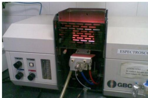
**Figura 4.** *Espectrofotómetro de Absorción Atómica GBC-932. (FACYT- UC. 2011)*
