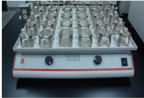
**Figura 6.** *Agitador Orbital marca BUNSEN. (Laboratorio de Investigaciones Bioquímicas FACYT-UC 2011)*
