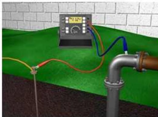
**Figura 27a. Medición de resistencia**
