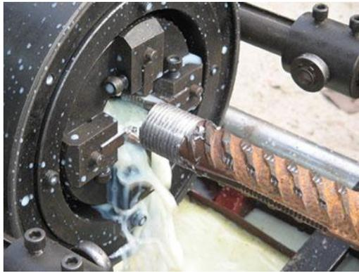
Figura 16. **Empalme mecánico de barras de acero.** Nota. Datos tomados de: <http://www.tradeines.com/product-bending-machinery/threading-rolling-machine-514586.html>
