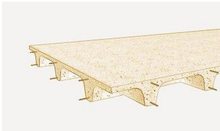
Gráfico 58. Losa Reticular. Nota. Datos tomados de [http://www.generadordeprecios.info/rehabilitacion/DEH/DEH022\\_0\\_0\\_3\\_0\\_0\\_1\\_0.html](http://www.generadordeprecios.info/rehabilitacion/DEH/DEH022_0_0_3_0_0_1_0.html)
