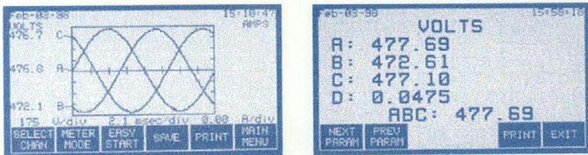
Figura 3.2. Mediciones típicas del PP1. Dranetz-BMI Inc.
