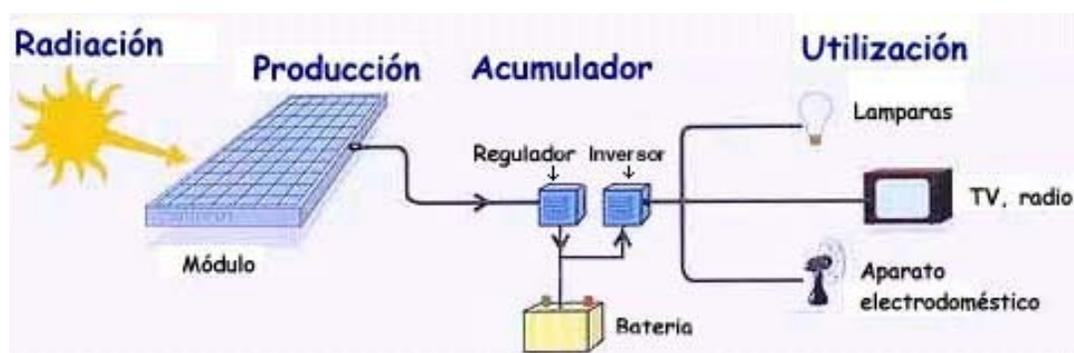
**Figura 4:** Esquema de un Sistema Fotovoltaico (Fuente: Caraballo, D. 2010)
