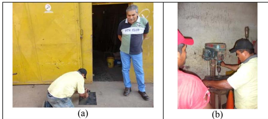
Figura 77. (a) Corte de lámina de hierro, (b) Perforación de lámina de hierro
