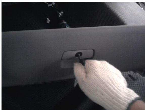
Fig. No. 17. Colocar cilindro de guantera
