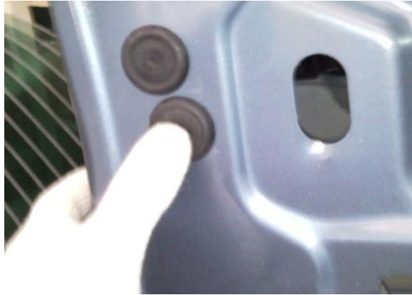
Fig. No. 19 Colocación de tapones en los orificios
