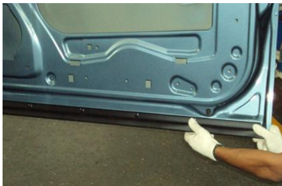
Fig. No. 13 Colocación de goma inferior de la puerta
