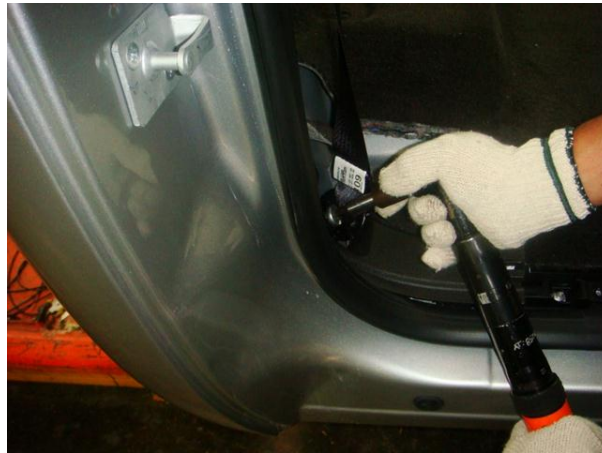
Fig. No. 15. Ajustar cinturón de seguridad
