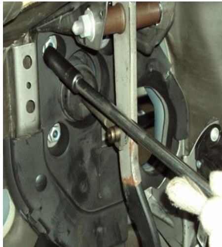
Fig. No. 16. Ajustar pedal del freno
