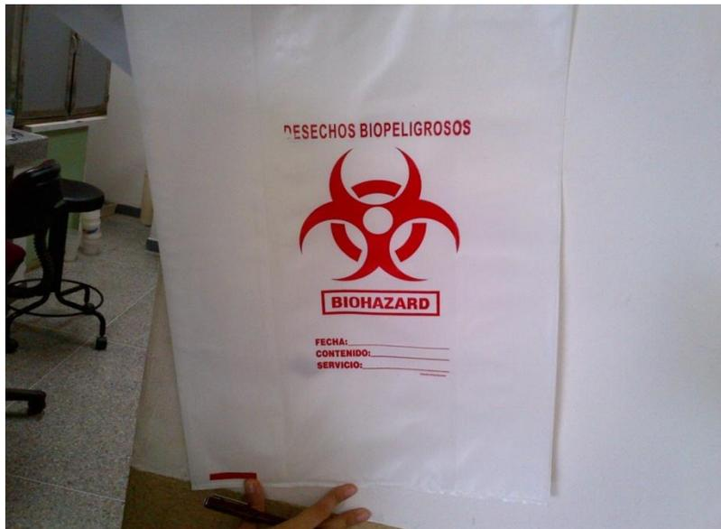
Figura 1. Bolsa de Polietileno de baja densidad color blanco opaco identificada con el término “Desechos Peligrosos” utilizada en los laboratorios de la Escuela de Bioanálisis. *Nota.* Hernández R y Conti C (2012)
