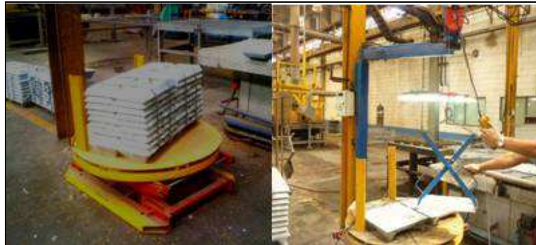
Figura 6.20. Mesa giratoria de nivelación y brazo mecánico de dosificación.
