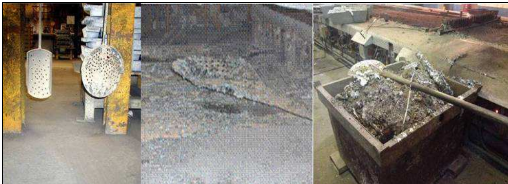
Figura 6.15. Herramientas para el sistema de extracción de escoria.
