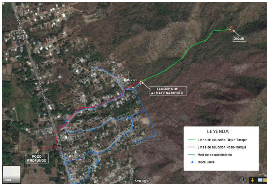
Figura 37. Georreferenciación del sistema de abastecimiento mediante GPS. Elaboración propia
