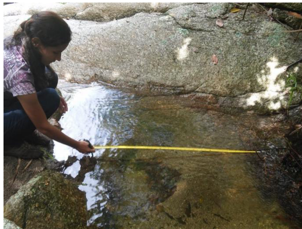
Figura 40. Toma de medidas en tramo uniforme para el aforo del dique: distancias, secciones transversales y tiempo de viaje desde un punto de inicio a otro.
