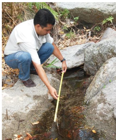
Figura 40. Toma de medidas en tramo uniforme para el aforo del dique: distancias, secciones transversales y tiempo de viaje desde un punto de inicio a otro.
