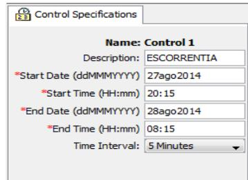
**Gráfico 46.** Especificaciones de control correspondiente a 12 horas de modelado.
