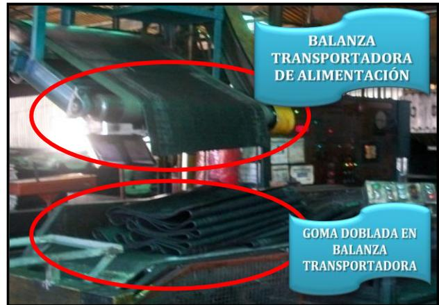
**Figura IV.7.** Banda Transportadora de Alimentación y Balanza Transportadora.
