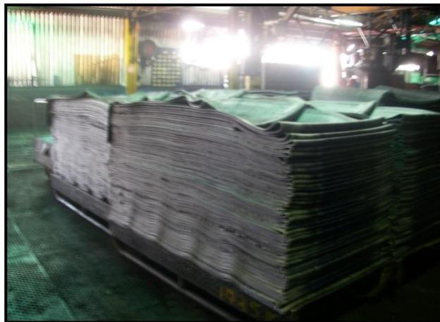
**Figura III.1.** Goma laminada fabricada en las máquinas Banbury 1 y 2
