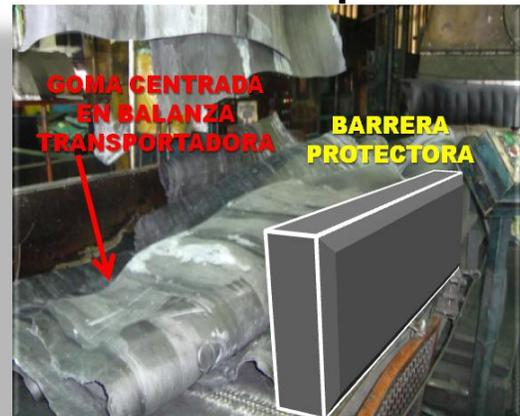
**Figura V.7.** Antes y Después de la Propuesta de Instalación de la Barrera de Protección Derecha de la Balanza Transportadora del Banbury 1.
