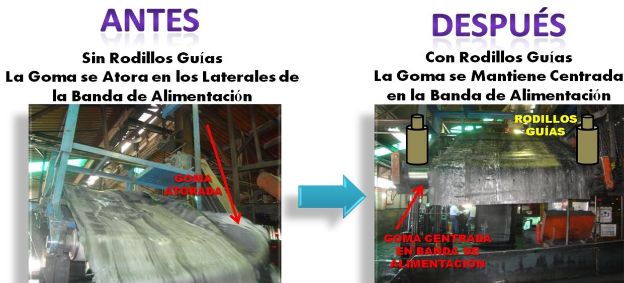
**Figura V.11.** Antes y Después de la Propuesta de Instalación de Rodillos Guías de la Banda de Alimentación de los Banbury 1 y 2.
