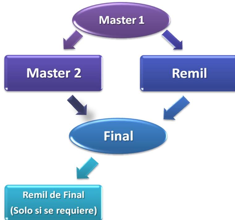
**Figura III.2.** Secuencia de fabricación de gomas para la obtención de las gomas finales.
