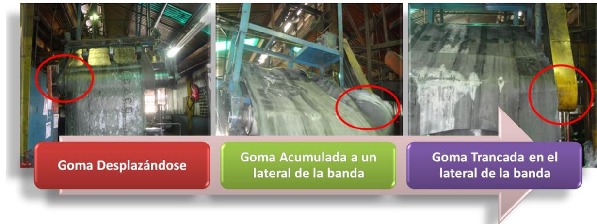
**Figura IV.10.** Secuencia de enredo de goma con los laterales de la banda transportadora de alimentación.
