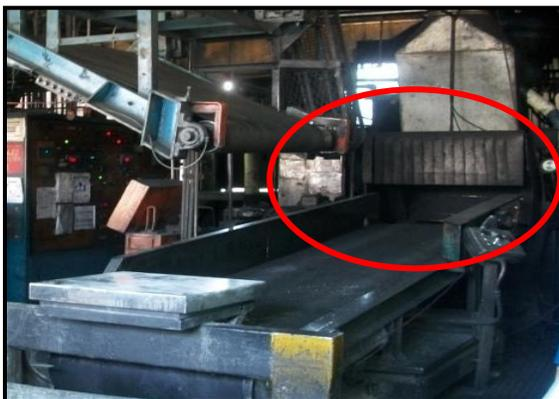
**Figura IV.8.** Balanza Transportadora y entrada de compuerta.
