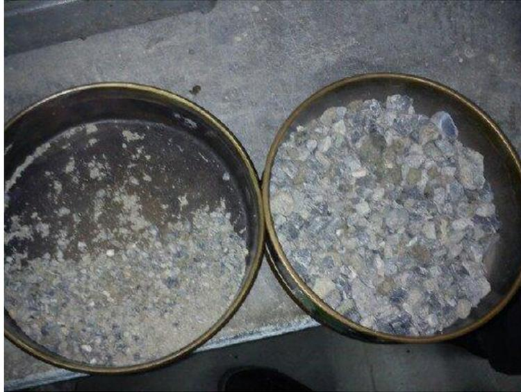
Figura 13. *Ensayo de los agregados Granulometría AF.*
