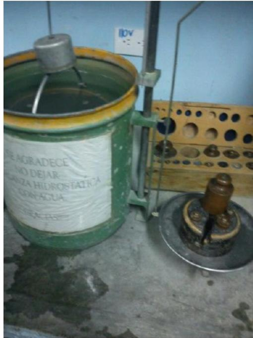
Figura 15. *Ensayo de los agregados Absorción .AG.*
