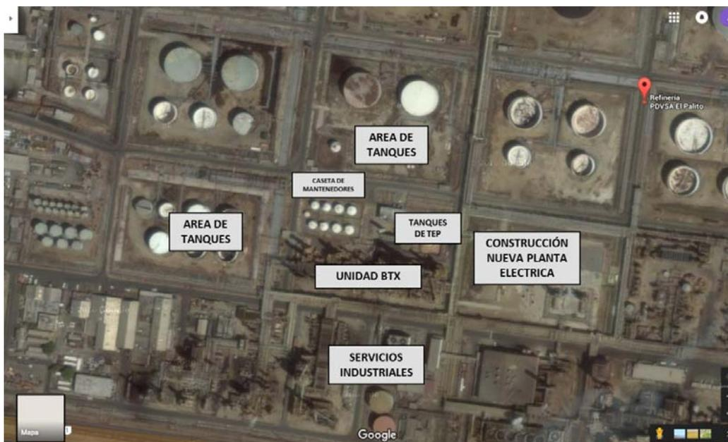
**Figura 8.** Ubicación espacial de los tanques de TEP respecto a las demás instalaciones de la REP.
