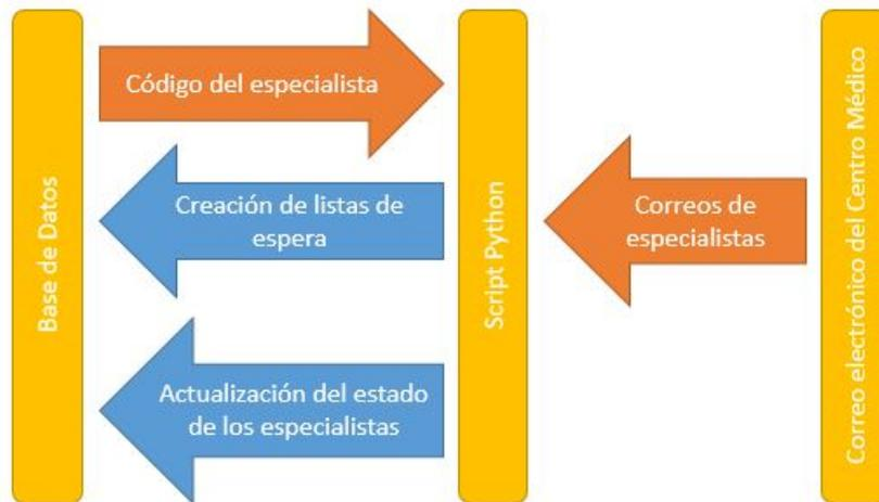
Figura 3.10: Diagrama de funcionamiento del Script en Python.
