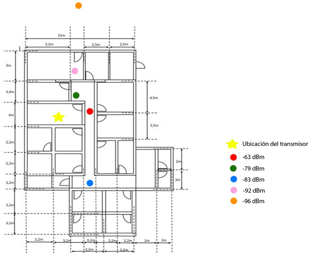
**Figura 4.2:** Plano Dimetel sede Bárbula con mediciones del RSSI en diversos puntos.
