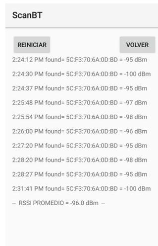
**Figura 4.5:** Medición del RSSI a 18 m del transmisor.
