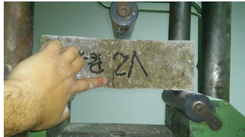
FALLA DE LA VIGUETA
