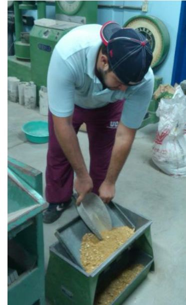
CUARTEO DEL AGREGADO FINO
