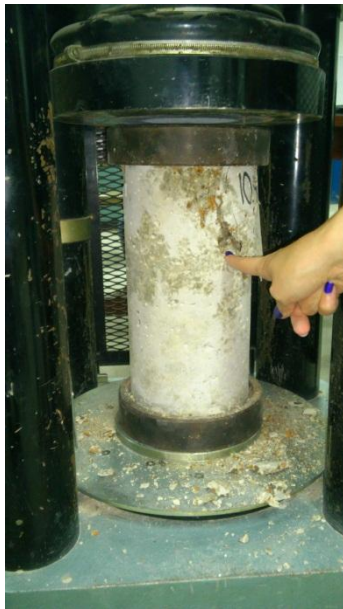
FALLA DEL CILINDRO
