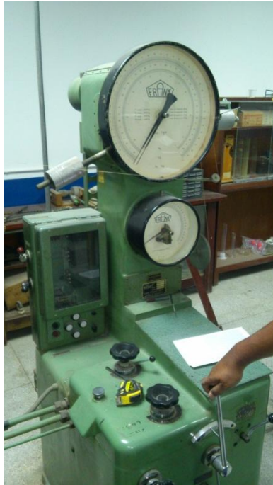
LECTURA DE CARGA MÁXIMA A FLEXIÓN
