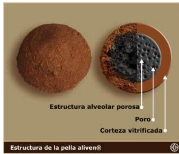
Figura 2. Estructura de la pella Aliven®. Nota. www.aliven.com.ve
