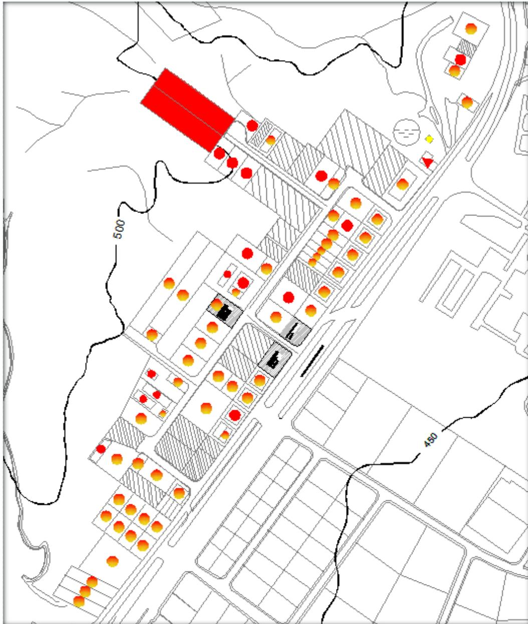
Figura 50. Mapa de Estimación de Daños con  $A_0=0.3$ , Sector 4: Urb. Industrial Terrazas de Castillito. Nota. Datos Tomados de Aldazoro y Da Silva (2012).
