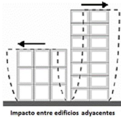
Figura 19. **Edificios adyacentes propensos a golpeteos entre sí.** Nota. Datos tomados de <http://www.civil.cicloides.com/cestructurales/2.2.4/>
