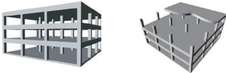
Figura 10. **Edificación con un sistema aporticado.** *Nota.* Datos tomados de <http://www.civil.cicloides.com/cestructurales/2.3.1/>
