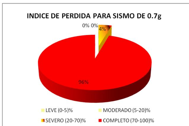
Figura 41. Distribución de daño para un sismo de 0,7g. A un total de 1999 edificaciones. Nota. Datos Tomados de Aldazoro y Da Silva (2012).
