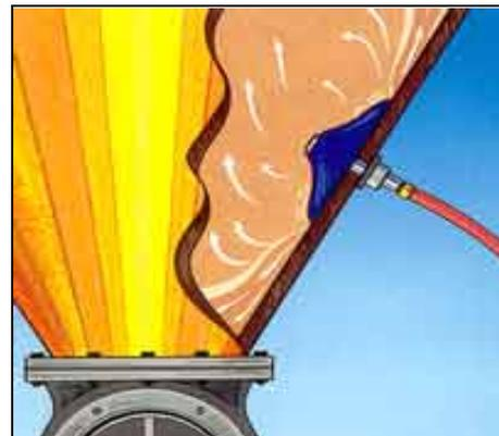
**Figura 4.17.** Sección de la tolva que muestra la acción del vibrador en funcionamiento.
