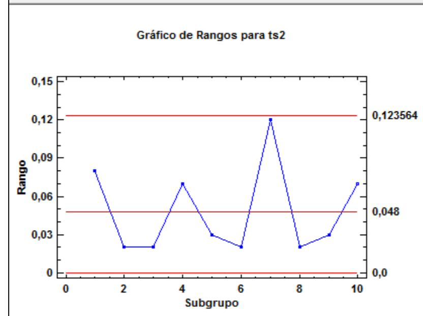
Figura 4.10. Gráfico X-R del parámetro reométrico ts2.
