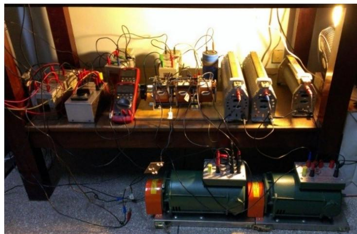
**Figura 3.3 Montaje del sistema de potencia.**
