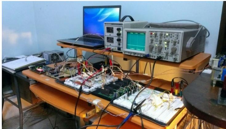
**Figura 3.11 Montaje del esquema de control y circuito de disparo.**
