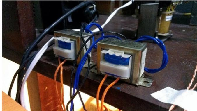
**Figura 3.18 Transformadores de tension, usados como sensores para las tensiones de fase de la red.**
