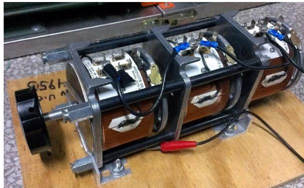
**Figura 3.7 Autotransformador trifásico del esquema de potencia.**
