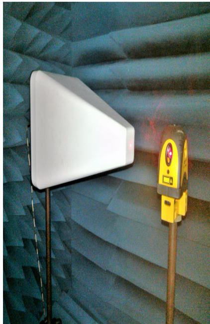
**Figura 3.5:** Alineación de la antenna patrón con la antenna receptora usando un teodolito (instrumento amarillo con negro) - medición de parámetro  $S_{21}$
