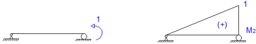
Figura 5.2.11: Sistema dos para el primer desplazamiento elemental
