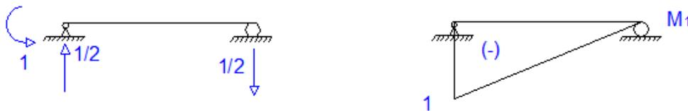
Figura 5.2.10: Sistema uno para el primer desplazamiento elemental
