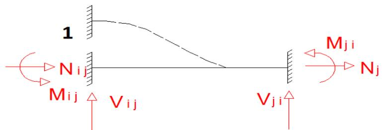
Figura 5.2.4: Tercer desplazamiento elemental
