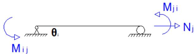
Figura 5.2.8: Sistema primario para el primer desplazamiento elemental
