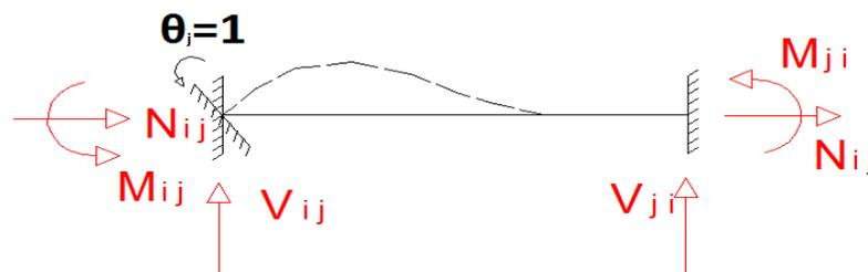
Figura 5.2.2: Primer desplazamiento elemental
