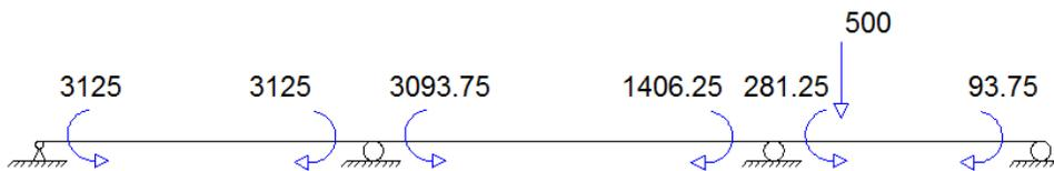
Figura 5.3.15: Sistema de cargas sobre toda la estructura. (Ejemplo Ilustrativo 5.3.1)
