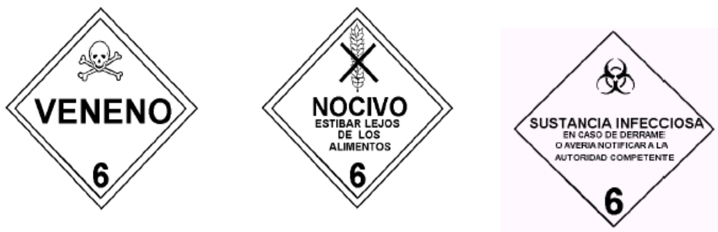
Figura 20. Señalización de Venenosos. Nota: Manual CBC-1 del Cuerpo de Bomberos de Concepción
