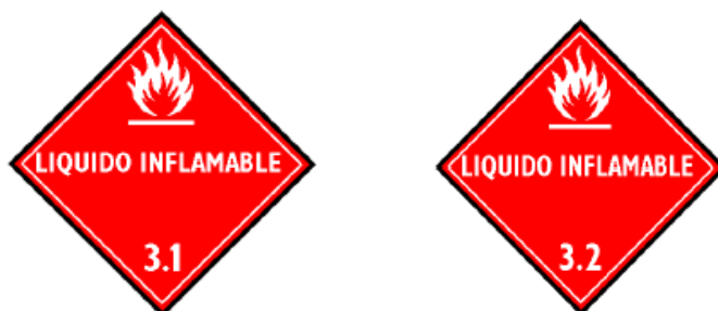
Figura 17. Señalización de Líquido inflamable. Nota: Manual CBC-1 del Cuerpo de Bomberos de Concepción.
