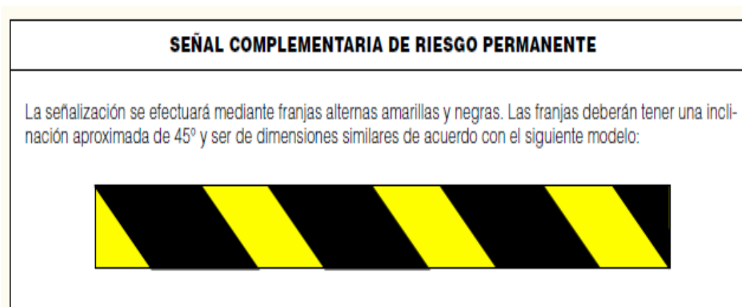
Figura 11. Señales de riesgo permanente. Nota: tomado del Anexo III del R.D.485/1997
