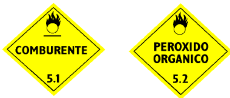
Figura 19. Señalización de Oxidantes. Nota: Manual CBC-1 del Cuerpo de Bomberos de Concepción
