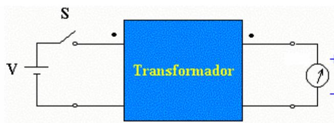
**Figura 2.51. Montaje de laboratorio usado para la determinación de los puntos correspondientes de un transformador.**
