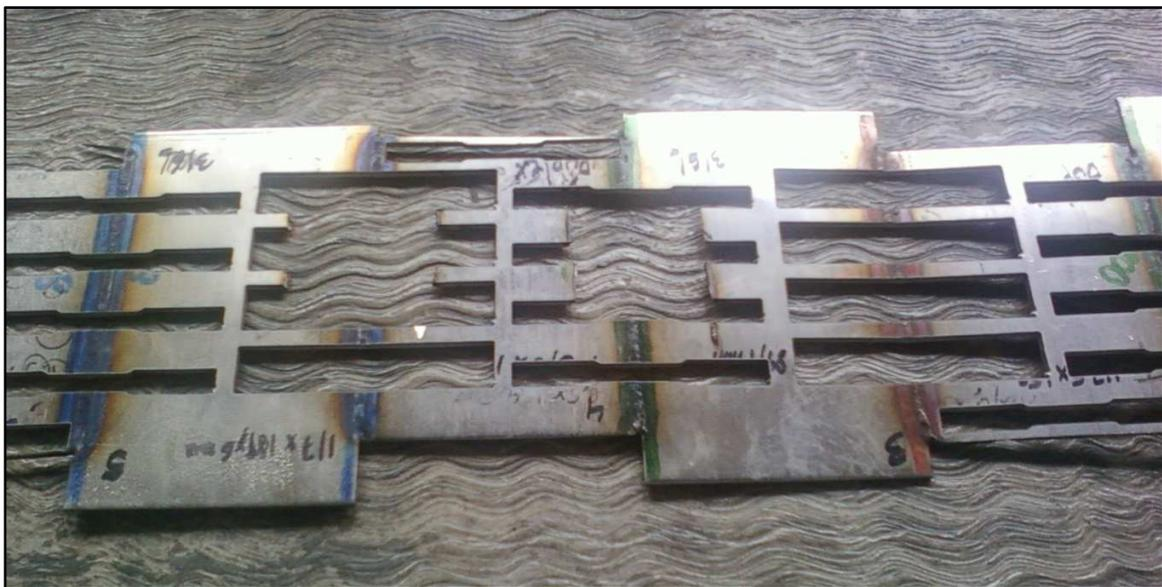
**Figura 3.** Corte de las probetas de ensayo.
