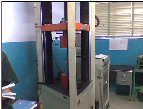
**Figura 3.5** Equipo para ensayo de tracción. Galdabini. Capacidad: 20 TON
