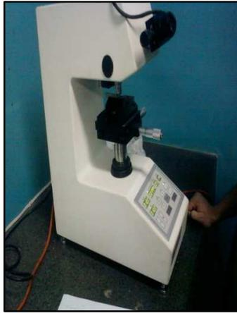
**Figura 3.9** Equipo para ensayo de dureza.
