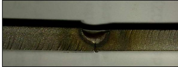
**Figura 4.2** Penetración obtenida para un rango de 80-100 A, en la unión disímil.
