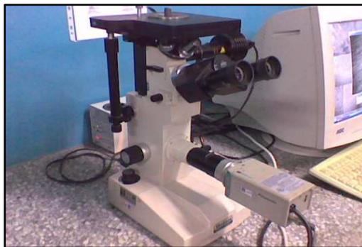
**Figura 3.8** Equipo para evaluación metalográfica.
