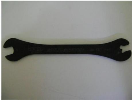
**Figura 4.4:** Llave de ajuste inserto-vástago ISCAR 4268745
