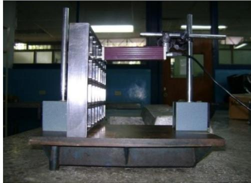
**Figura 3.9:** Vista lateral de montaje para medición de rugosidad
