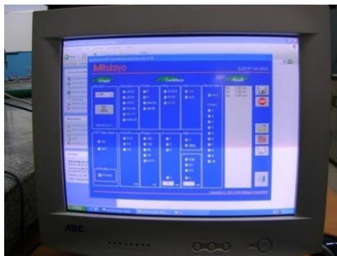
**Figura 3.11:** Software de recepción de datos Surftest SJ201®
