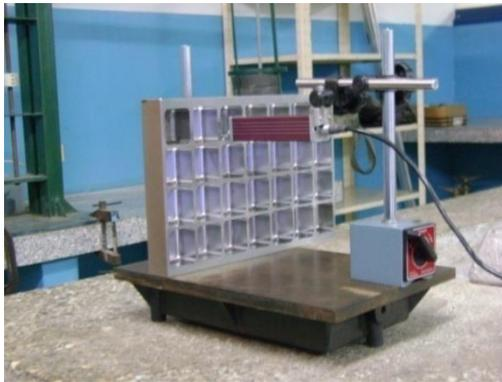
**Figura 3.10:** Vista en isometría del montaje para medición de rugosidad
