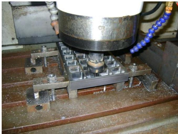
**Figura 4.6:** Molde M2 en proceso de mecanizado
