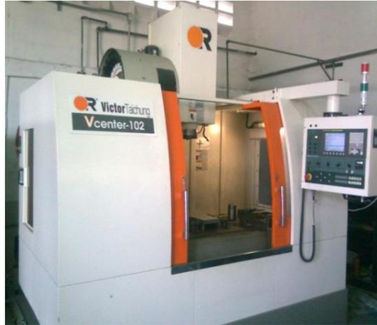
**Figura 3.2:** Centro de mecanizado CNC Victor/Taichung modelo Vcenter 102
