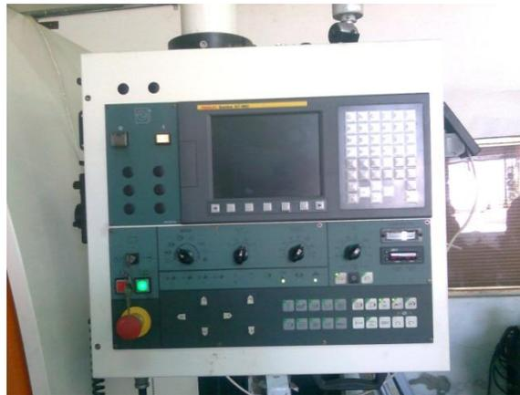
**Figura 3.3:** Tablero de control del centro de mecanizado CNC Victor/Taichung, modelo Vcenter 102
