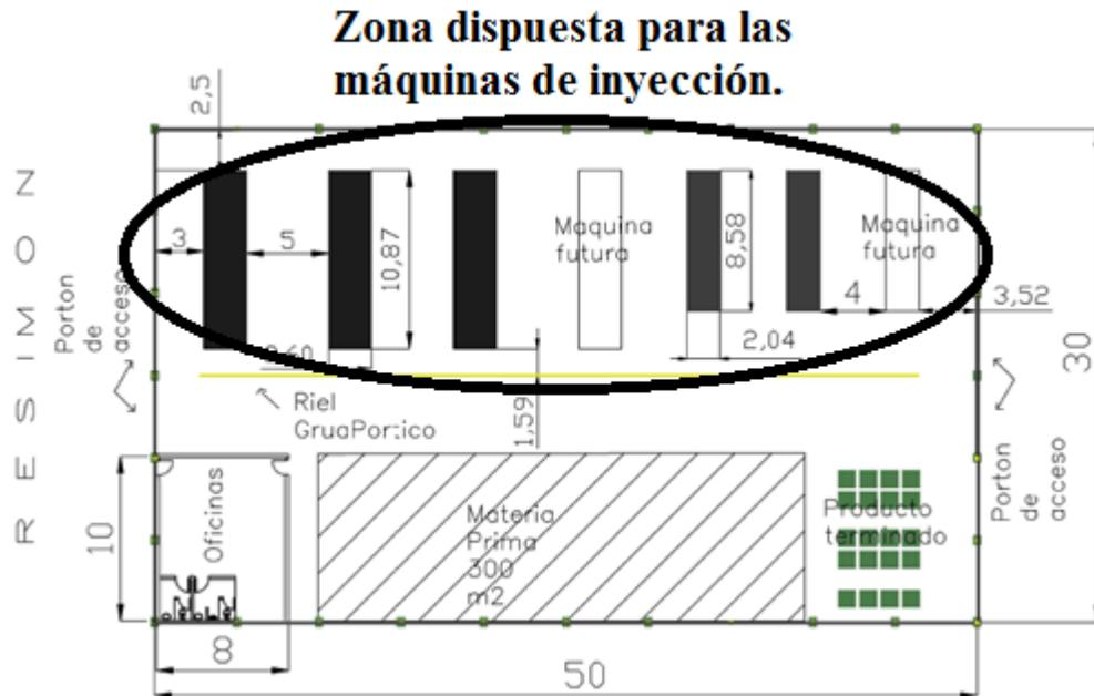
**Figura 3.1** Vista de planta del galpón de envases. (Medidas en metros)
