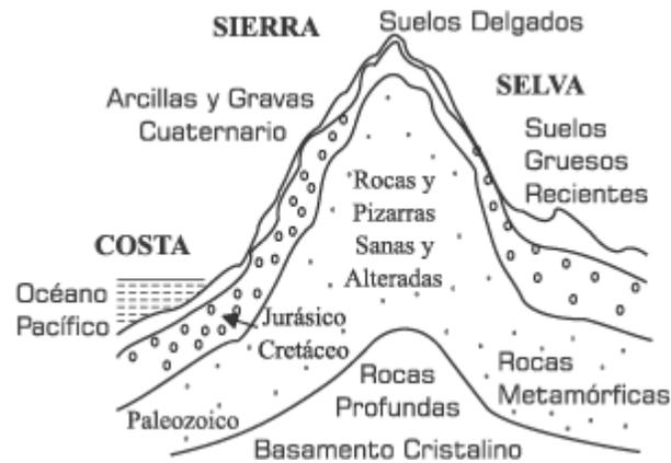
Fig. 2.9: Ejemplo de Suelo Estratificado
