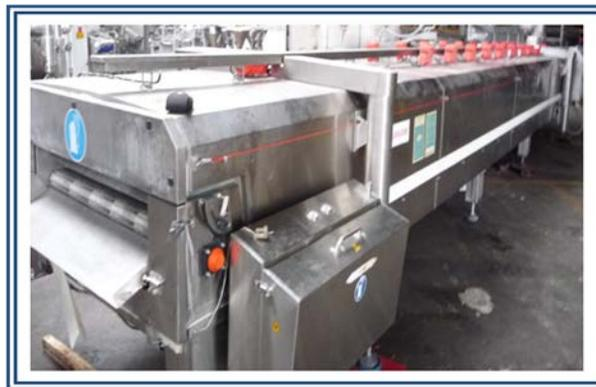
**Figura V.8 Túnel de Enfriamiento**
