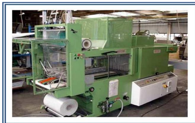
**Figura V.18** Empaquetadora
