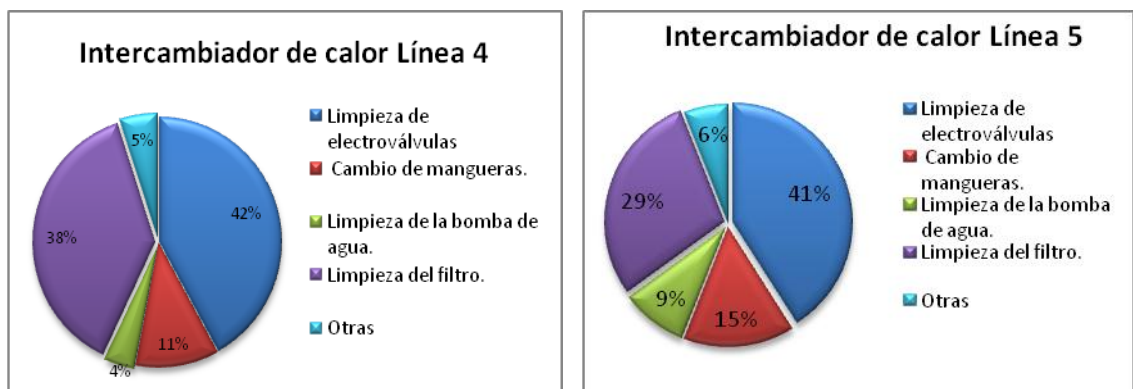
Figura 22. Fallas en el intercambiador de calor.
