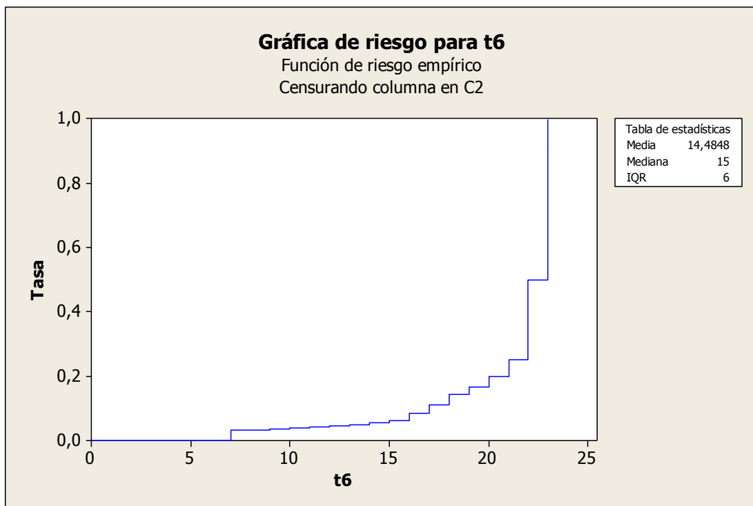
Figura 27. Análisis de riesgo de las fallas en las electroválvulas del intercambiador de calor
