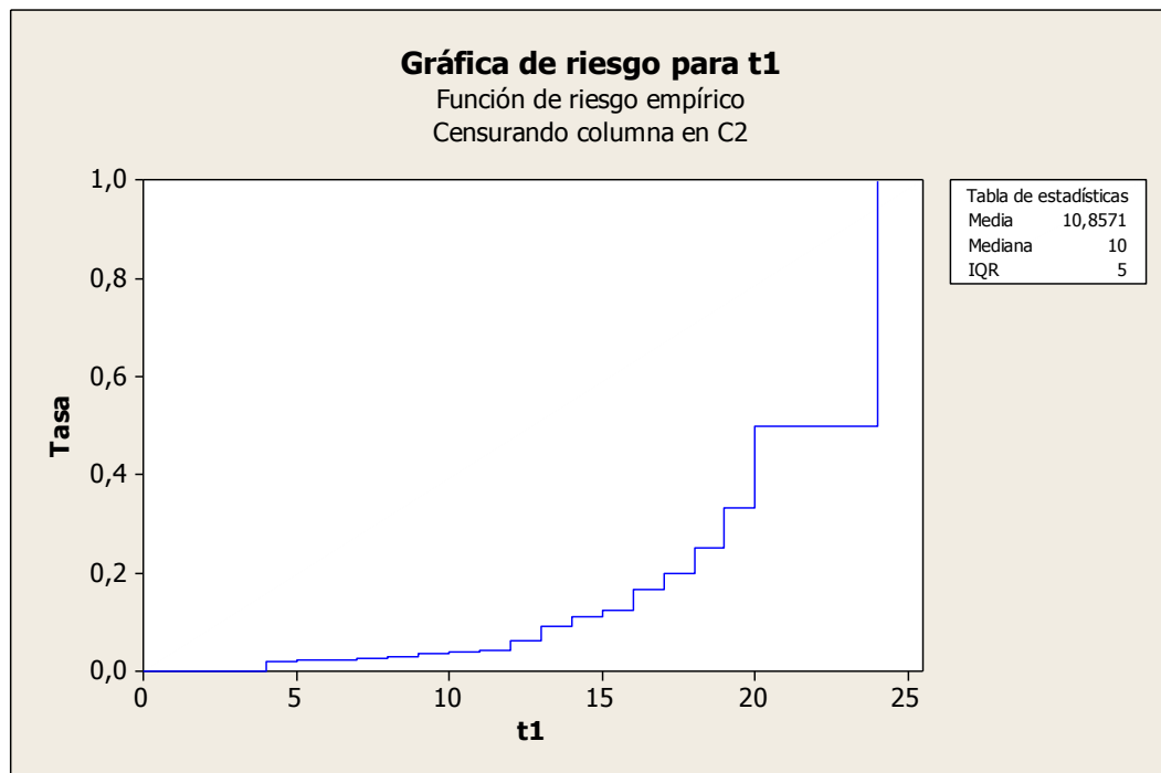
Figura 54. Análisis de riesgo por desajuste en la tornillería de los porta-mandriles
