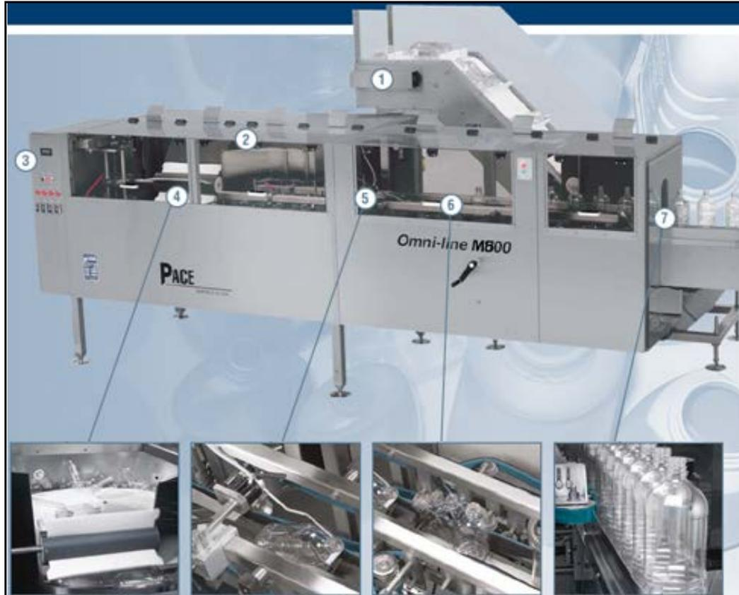
Figura V.2 Alimentador de botellas modelo M800 HS
