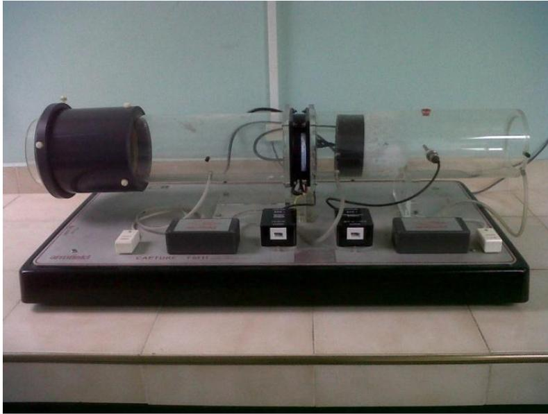
Figura 4.3. Equipo para realizar ensayos a ventilador axial FM11.
