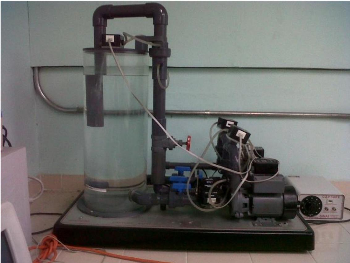
Figura 4.2. Equipo para realizar ensayos de bomba en serie y paralelo FM 21.
