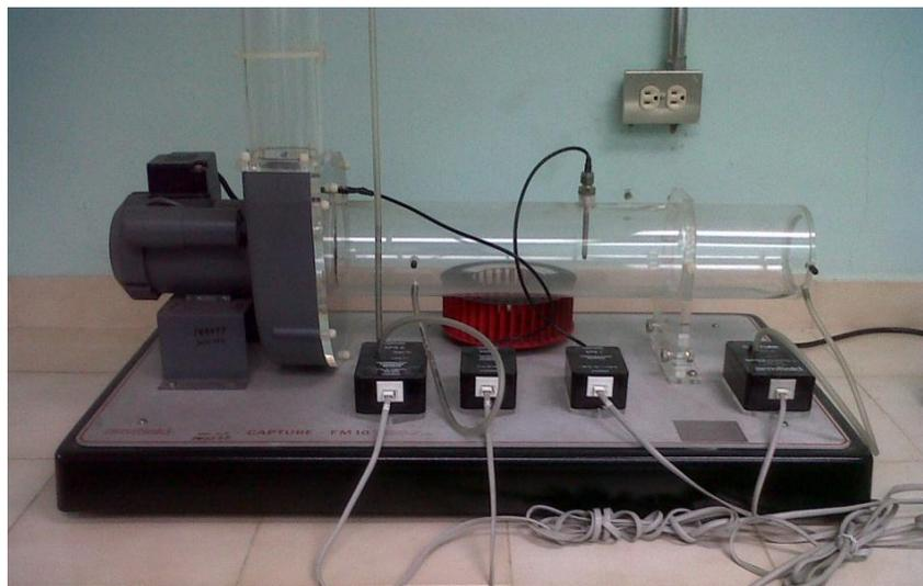
Figura 4.4. Equipo para realizar ensayos a ventilador centrífugo FM10.
