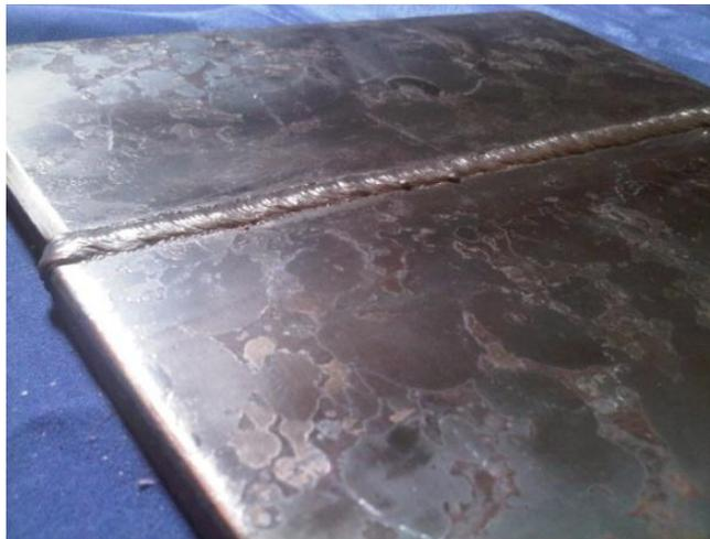
**Figura 3.6.-** Plancha A soldada con E6010.
