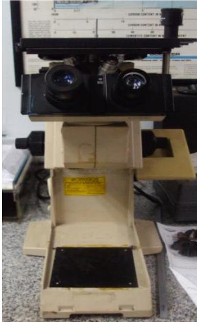
**Figura 3.15.** Microscopio metalográfico
