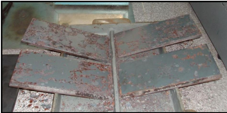
**Figura3.4.** Láminas de acero ASTM A36 después del Tratamiento térmico.
