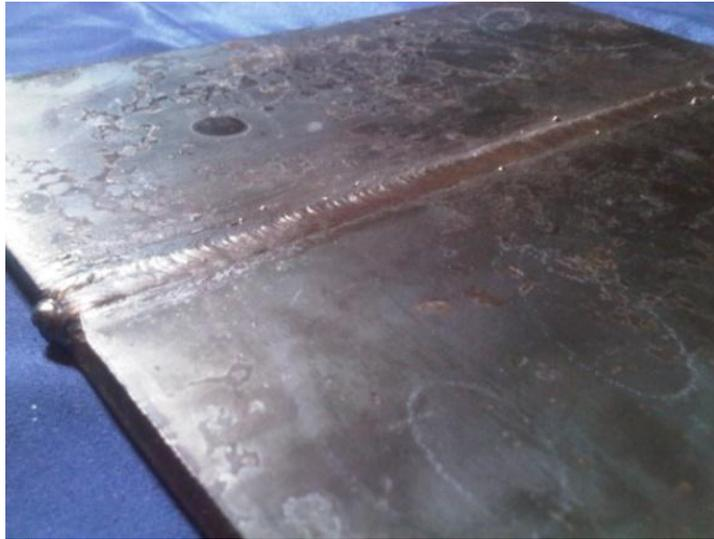
**Figura 3.7.-** Plancha B soldada con E6013
