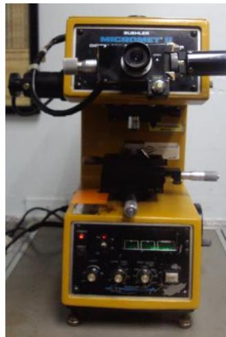
**Figura 3.12.-** Durómetro digital Micro Hordness Tester [fuente propia]
