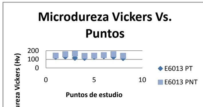
**Gráfica 4.2.** Microdureza Vickers vs punto probetas soldadas con electrodo E6013
