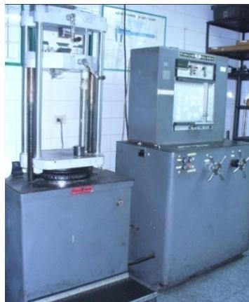
**Figura 3.14.-** Máquina universal de ensayo de materiales marca Tinius Olsen,
