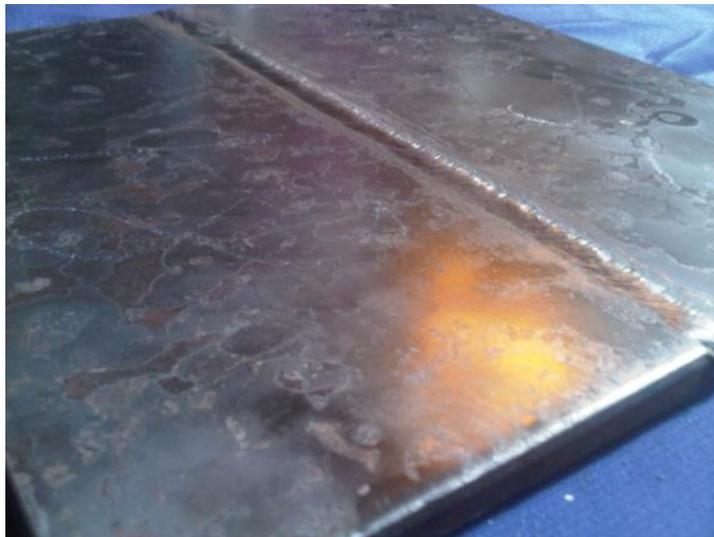
**Figura 3.8.-** Plancha C soldada con E7018.
