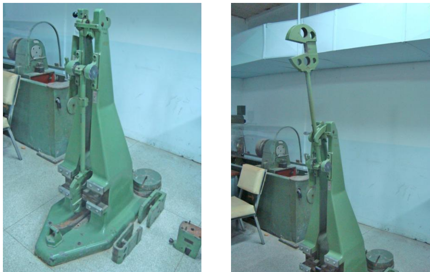
Figura 3.19 Péndulo de Impacto tipo Charpy utilizado en los Ensayos, Péndulo en Reposo (izquierda) y en posición de Ensayo (Derecha).
