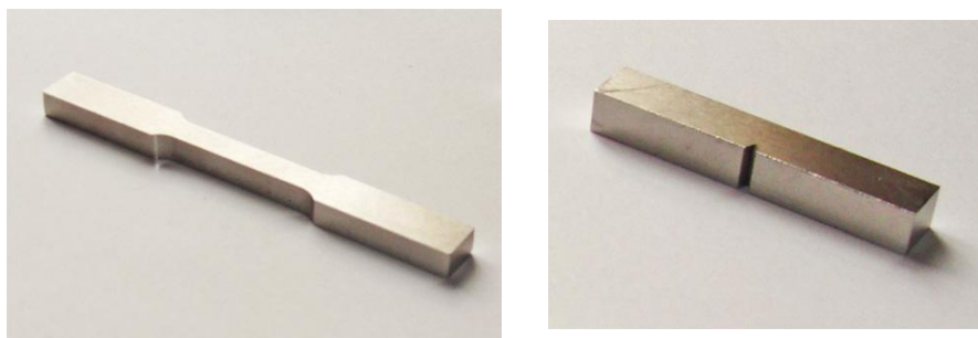
Figura 3.4 Probeta de ensayo de Tracción (Izquierda), Probeta de ensayo Charpy Derecha)
