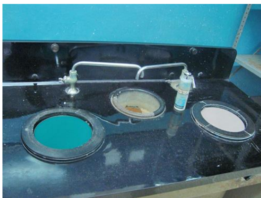
Figura 3.11 Banco de pulido utilizado
