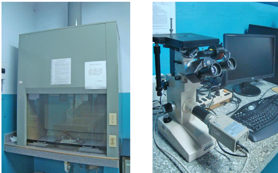
Figura 3.6 Campana para escape de Gases (Izquierda) y Microscopio Metalúrgico (Derecha)
