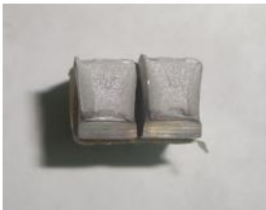
Figura 4.28 Fractura Tipo de muestra ensayada a Impacto tipo Charpy, Total (Izquierda) y Parcial (Derecha)
