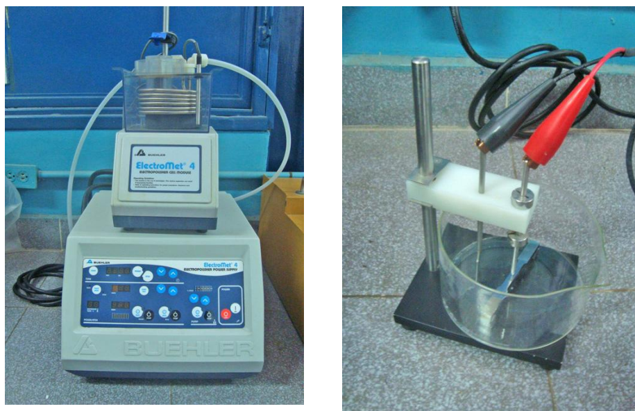
Figura 3.5 Equipo de Ataque Electrolítico, Fuente de poder (Izquierda) y Celda de Ataque (Derecha)
