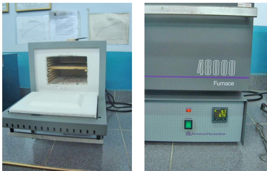
Figura 3.9 Configuración del Horno para realizar la sensibilización
