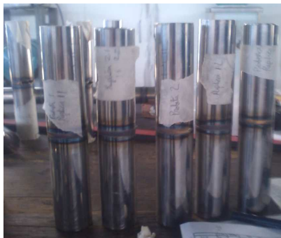
Figura 3.7. Tubos soldados, diámetro 1-1/2" y longitud 200 mm. (Fuente propia)
