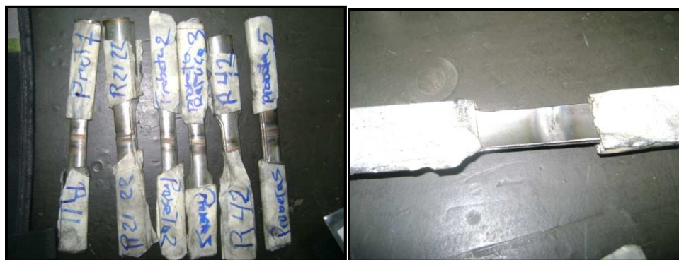
Figura 3.12. Probetas para el ensayo de tracción. (Fuente propia)
