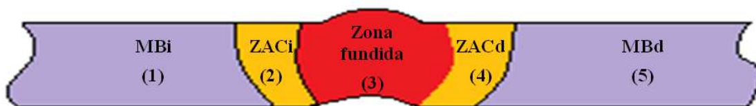
Figura 3.15. Distribución para las mediciones de dureza a lo largo de la sección transversal de las juntas soldadas. (Fuente propia)
