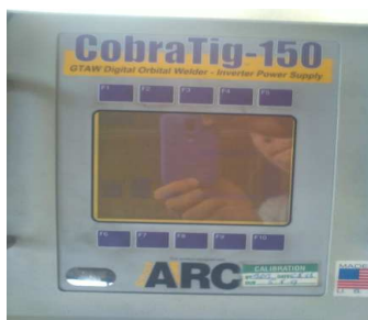
Figura 3.5. Panel de control CobraTig 150. (Fuente propia)
