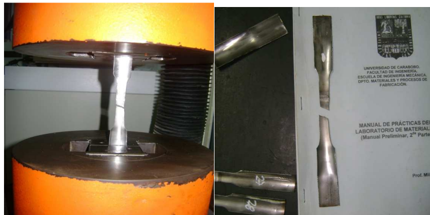
Figura 3.13. Probetas de tracción al alcanzar la ruptura. (Fuente propia)
