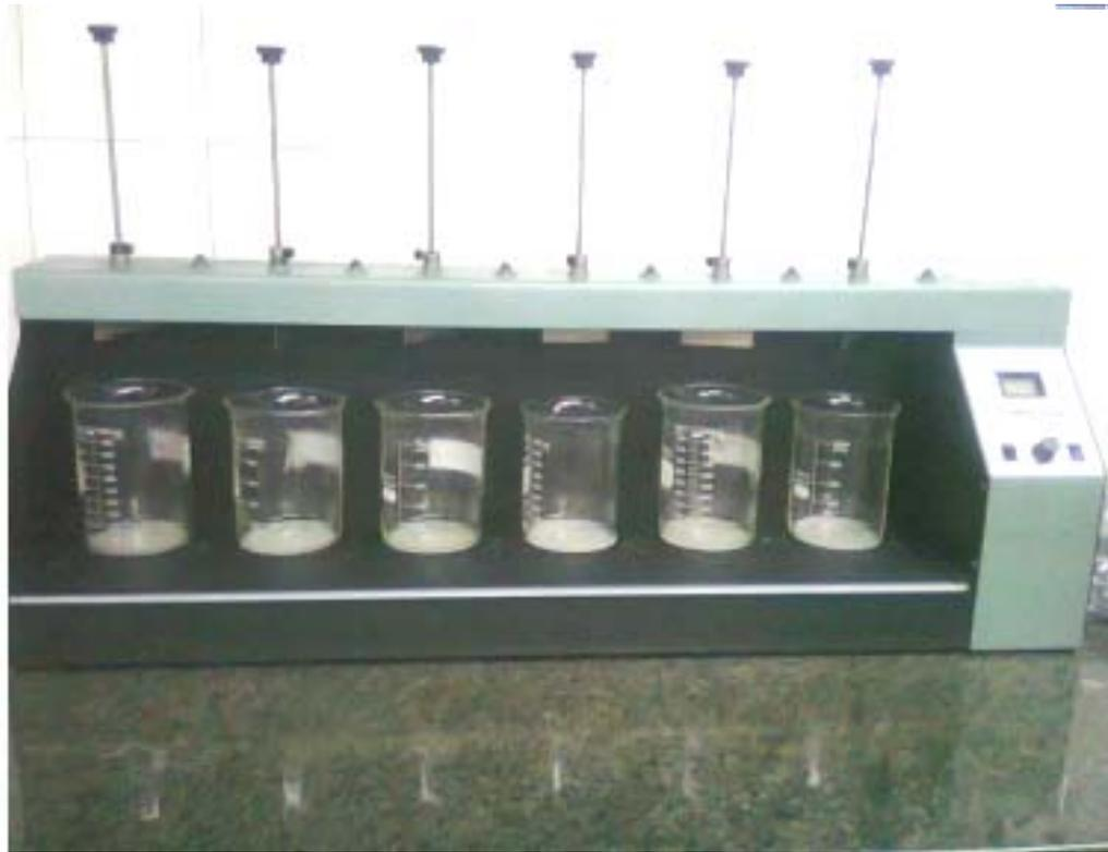
Figura 2.3 Equipo de jarra de 6 puestos, RPM de 10-100, con base iluminada (Fisher 15- 443-50 y 15-443-55).
