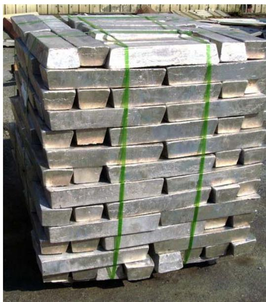
Figura 4.1 Forma geométrica de los lingotes de aluminio.
