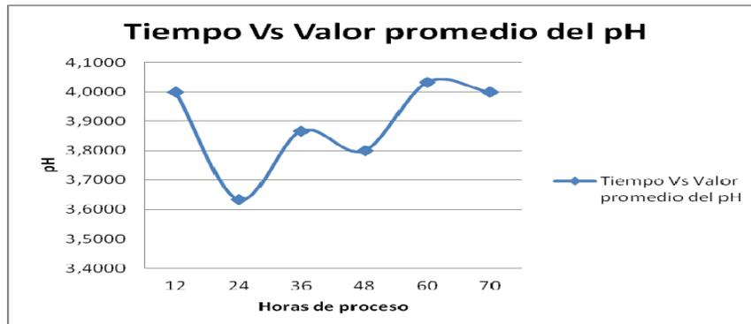
Figura 4.5 pH del policloruro de aluminio Vs tiempo de fabricación del PACl.
