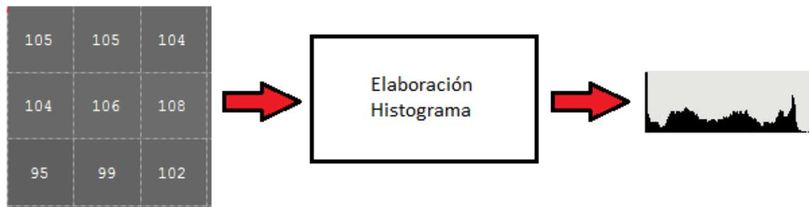
**Figura 5.8.** Diagrama de bloques donde se indican los parámetros de entradas al bloque *Elaboración Histograma* y los parámetros de salida.
