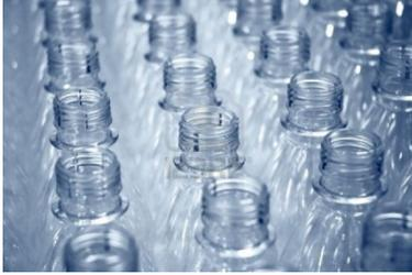
Para evitar pérdidas, las botellas vacías son inspeccionadas antes del llenado, para verificar deformidades y desgastes. Cualquier botella vacía dañada en el transporte tiene que ser detectada y separada de la línea de producción.
