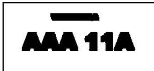
**Figura A.31.** Visualización del resultado obtenido posterior a la erosión de la imagen con un elemento estructurante definido como un cuadrado de 5\*5.
