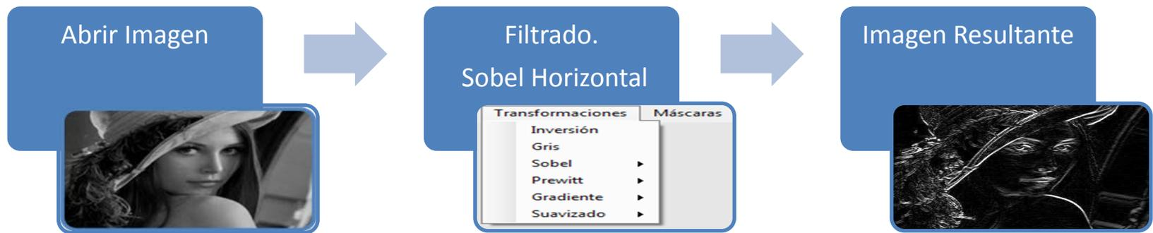
**Figura 7.11.** Diagrama de bloques con resultados de la aplicación de ventanas de Sobel Horizontal a la imagen en escala de grises
