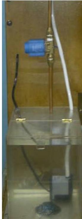
**Imagen 4.13.** Conexión de la bomba y válvula solenoide.
