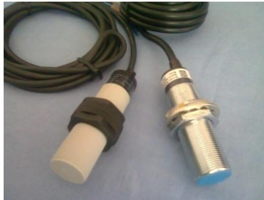
**Imagen 4.15.** Sensores capacitivos usados.
