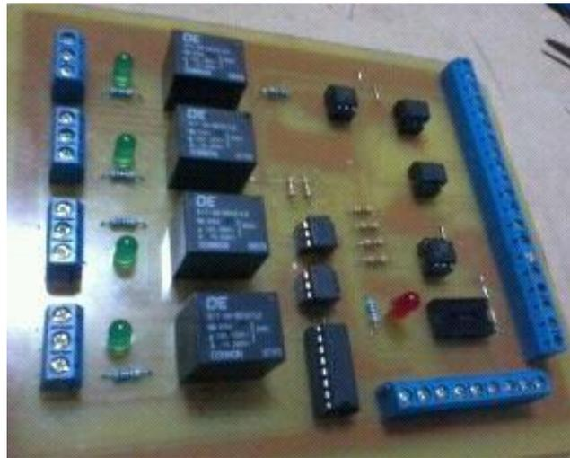
Imagen 4.19. Tarjeta diseñada para conectar con la DAQ
