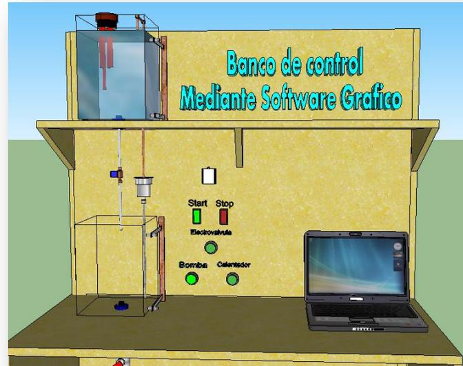
**Imagen 5.6.** Representación del sistema de vaciado y llenado de tanques mediante variación de temperatura por medio de ecuaciones.
