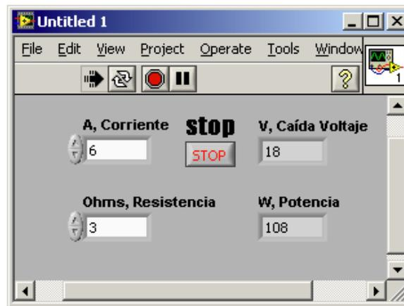
**Imagen 2.37.** Panel Frontal de un Control Numérico
