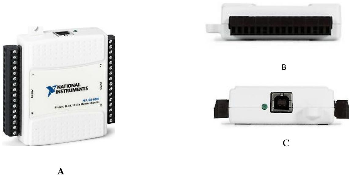
**Imagen 4.4.1.** Imágenes de la Tarjeta de Adquisición de Datos. A) Vista Frontal. B) Vista Frontal donde van conectados los cables. C) Vista del conector USB.
