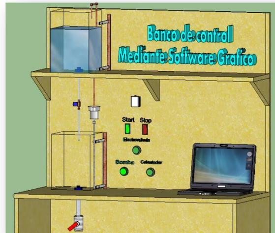
**Imagen 5.2.** Representación del sistema de vaciado y llenado de tanques
