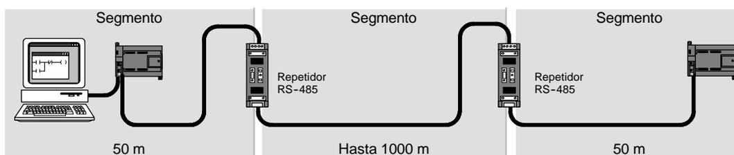
Figura 7-21 Ejemplo de una red con repetidores
