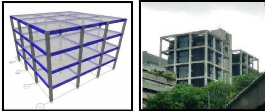
Figura 26. Porticos de concreto armado.
