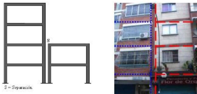
Figura 55. Adosamiento: losa contra losa.
