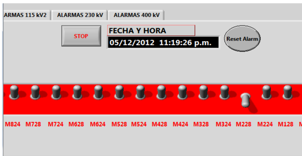
Figura 17. Control del seccionador M228 abierto.
