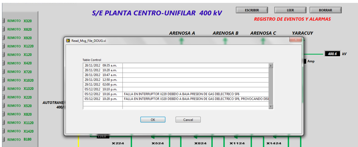
Figura 13. Ventana con la lista de eventos ocurridos en la subestación.
