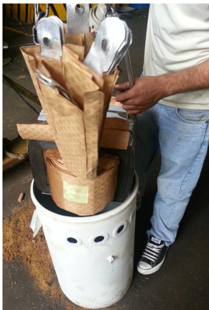
Figura 5.15: Incubando las bobinas y el núcleo. Autores: Cabrera Pedro, Gutiérrez Adrian
