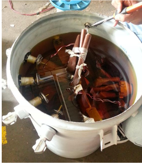
Figura 5.19: Soldando los cables de los sensores. Autores: Cabrera Pedro, Gutiérrez Adrian
