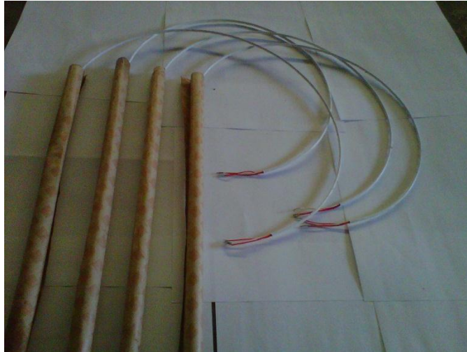
Figura 4.1: Recubrimiento de los sensores de temperatura. Autores: Cabrera Pedro, Gutiérrez Adrian.
