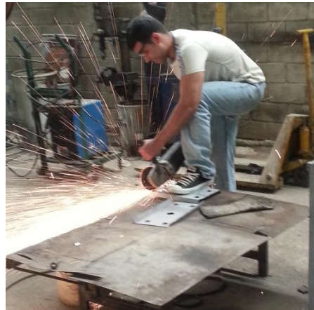
Figura 5.14: Cortando la escuadra interna donde irán colocadas las bobinas y el núcleo. Autores: Cabrera Pedro, Gutiérrez Adrian
