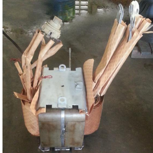
Figura 5.13: Bobinas y núcleo ferromagnético. Autores: Cabrera Pedro, Gutiérrez Adrian
