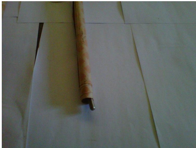
Figura 4.2: Recubrimiento con papel aislante de los sensores. Autores: Cabrera Pedro, Gutiérrez Adrian.
