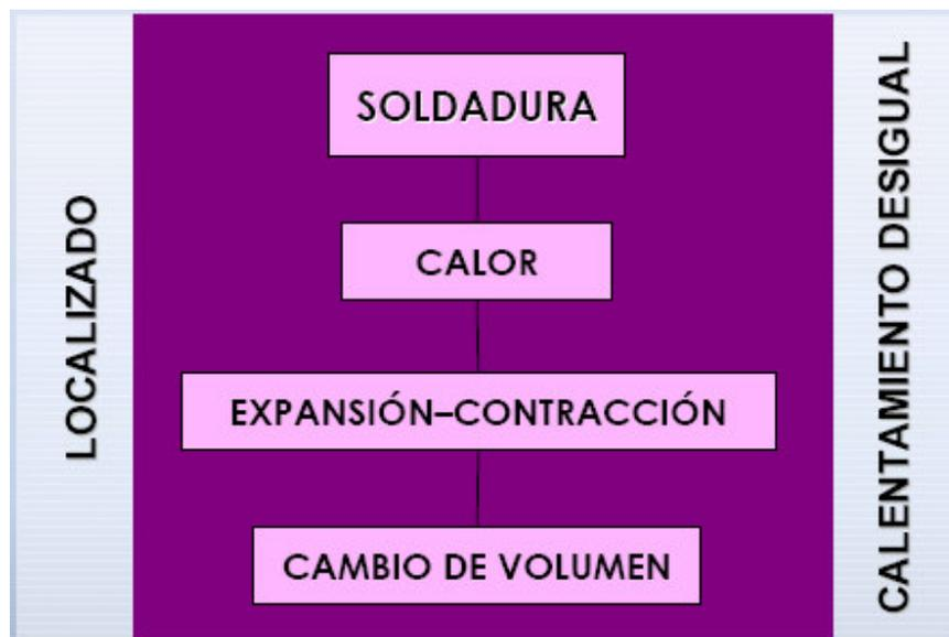
**Figura 5.-** Esquema de formación de los esfuerzos residuales.
