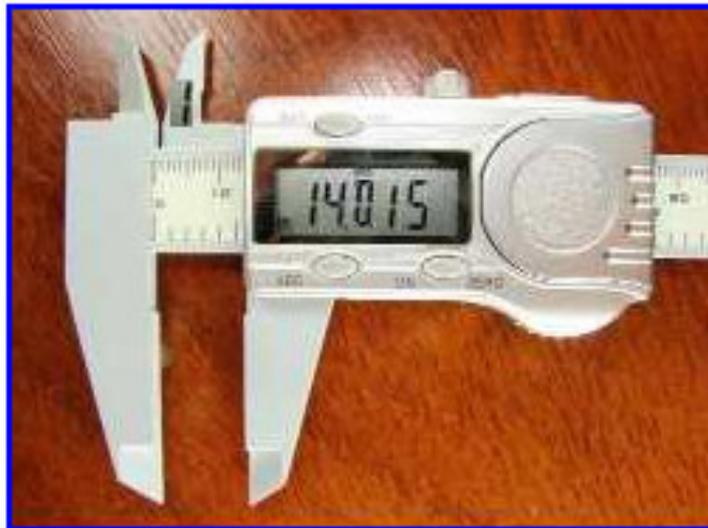
**Figura 25.-** Vernier digital utilizado para medir el alargamiento.
