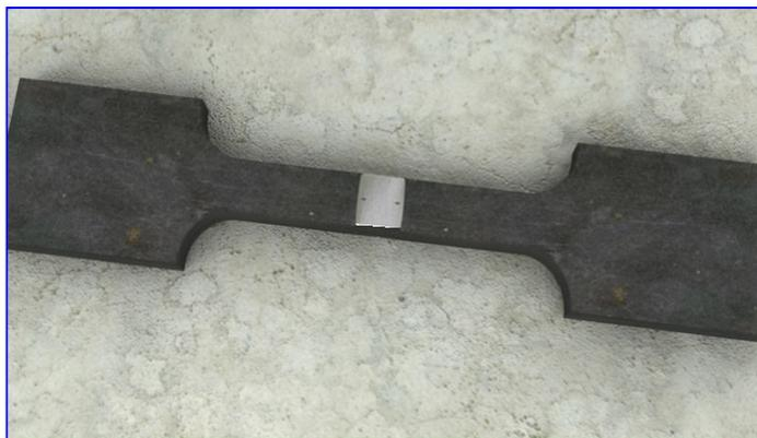
**Figura 24.-** Muestra de probeta con marcas realizadas.
