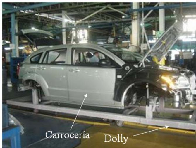
**Figura N° 4.7. Vehículo al final de la línea de tapicería.**
