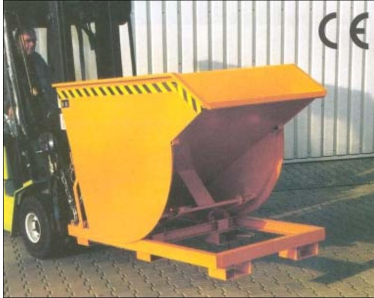
que el procedimiento para la carga de este material resulta engorroso, se propone utilizar un contenedor con un diseño que permita la carga de este material al horno, sin la necesidad de utilizar la herramienta llamada “burro de carga” y el apoyo del montacargas de manejo de materiales. En la Figura VI-3 se muestra la propuesta del contenedor.
