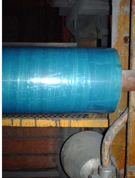
Rodillo recubierto de mylar tape
