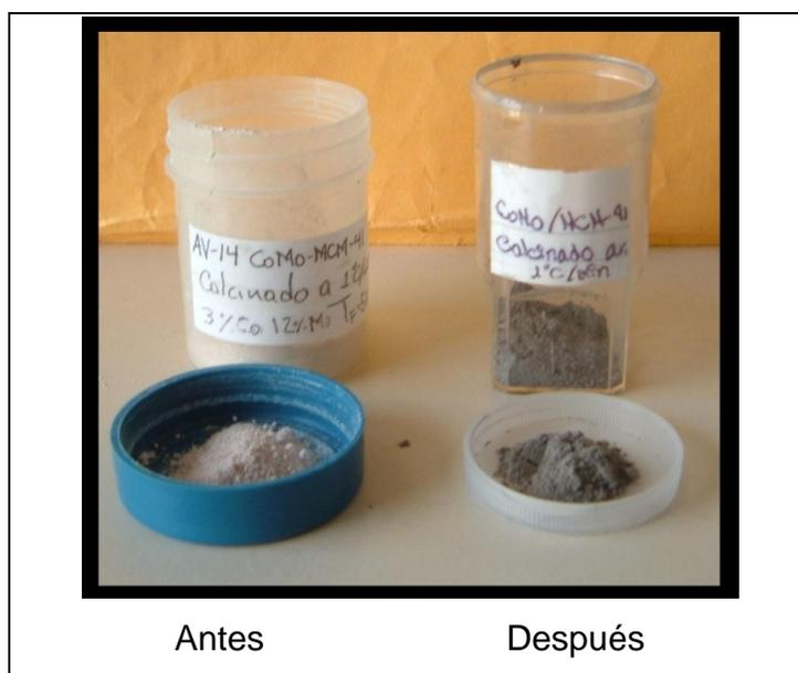
**Figura 4.7 Catalizador CoMo/MCM-41 calcinado a 1,0°C/min antes y después de reacciones de hidrotratamiento.**
