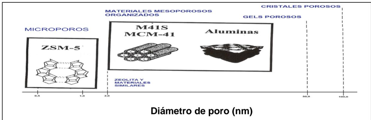
Figura 2.23. Clasificación del material según diámetro de poro.
