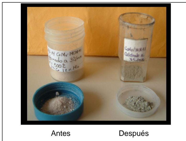
**Figura 4.9 Catalizador CoMo/MCM-41 calcinado a 3,0°C/min antes y después de reacciones de hidrotratamiento.**
