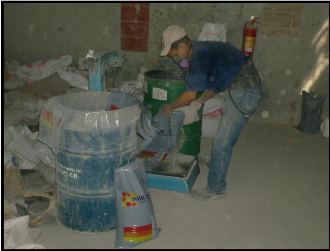
Figura 4.7 Bidón de la mezcla en seco para el llenado de sacos.
