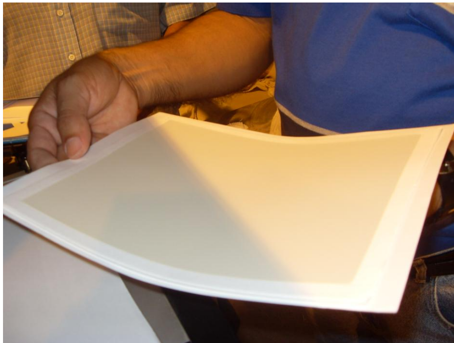
Figura B.3 Filtro utilizado en los equipos de medición de la concentración de partículas suspendidas tanto para PTS como PM10.
