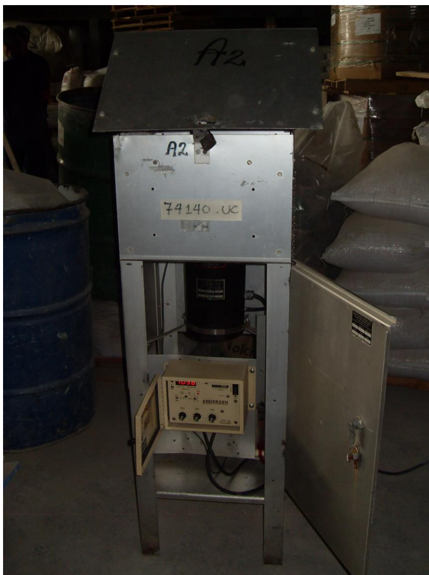
Figura B.1 Equipo de medición de partículas totales suspendidas (PTS) de alto volumen (High Volumen Sampler PTS).
