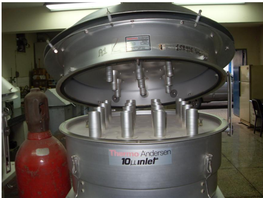
Figura B.2 Equipo de medición de partículas de alto volumen menores a PM10 (High Volumen Sampler PM10).
